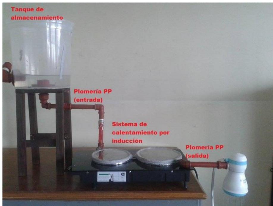
**Figura 22: Implementación del proceso para la ejecución de las pruebas del calefón prototipo a inducción**
