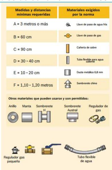
Figura 52: Elementos necesarios para la instalación
