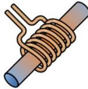
**Figura 7: Bobina helicoidal de varias espiras**
