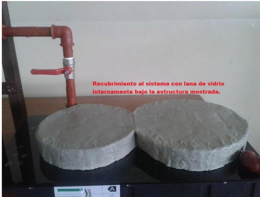
**Figura 23: Sistema de calentamiento por inducción recubierto de lana de vidrio bajo la estructura mostrada**
