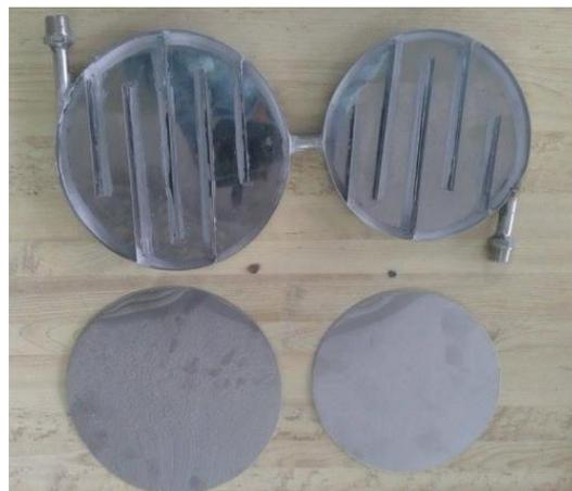
**Figura 20: Sistema de calentamiento por inducción con estructura interna tipo serpentín condensador**
