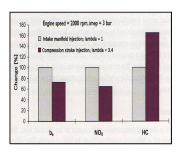
Estratificación en funcionamiento a carga parcial óptima para la combustión
