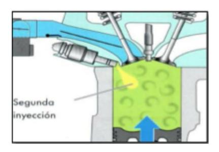
Convertidores catalíticos de calefacción pueden ser acelerados mediante la distribución de la cantidad de combustible en múltiples inyecciones.
