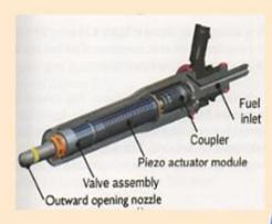
Los elementos piezoeléctricos están precargados utilizando un resorte. Esto evita la formación de esfuerzo de tracción en el estado desplazado protegiendo así el actuador contra daños.
