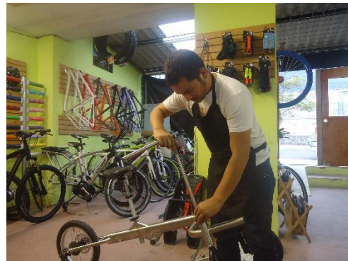
Figura 15 Montaje de la Tricicleta carriola
