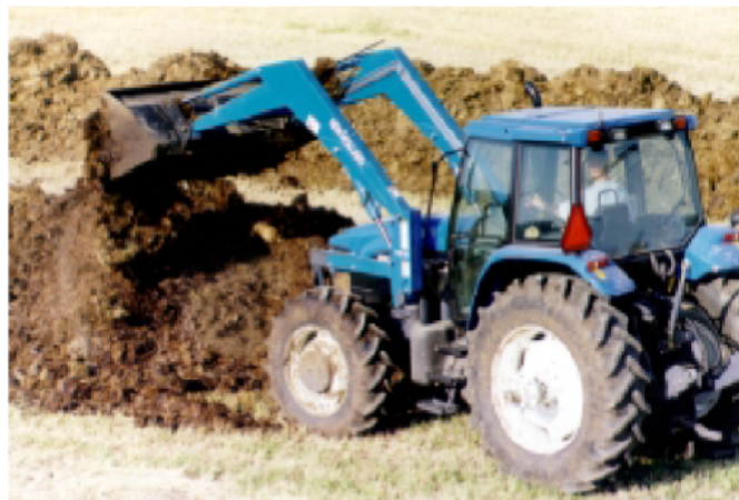
Figura 22 Pala cargadora volteando pila de compost Fuente:(Alvarez, 2003)
