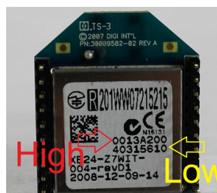
Figura 3.9: Número serial ubicado en parte posterior de módulos XBee
