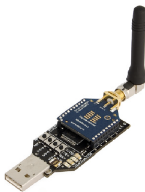
Figura 3.11: Colocación del módulo XBee en el Gateway
