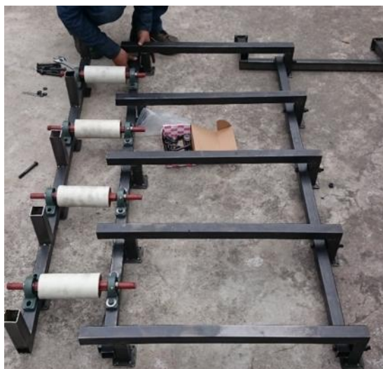
Figura 247. Comprobación de medidas y colocación de cada uno de los perfiles una vez que fueron soldados.
