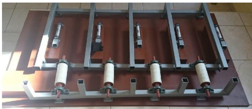
Figura 252. Atornillado y ubicación de cada uno de los mecanismos a la mesa.
