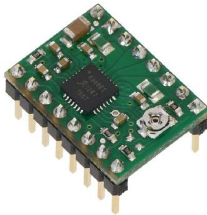
Figura 265. Driver de motor a pasos modelo A4988. (Pololu, 2015).
