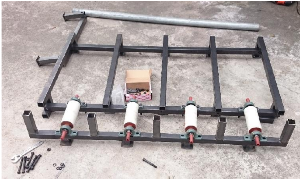
Figura 248. Pruebas del deslizamiento del tubo por la respectiva inclinación de un grado de la mesa.
