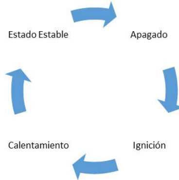
Figura 4.16: Ciclo de estados del sistema Balastro-lámpara.
