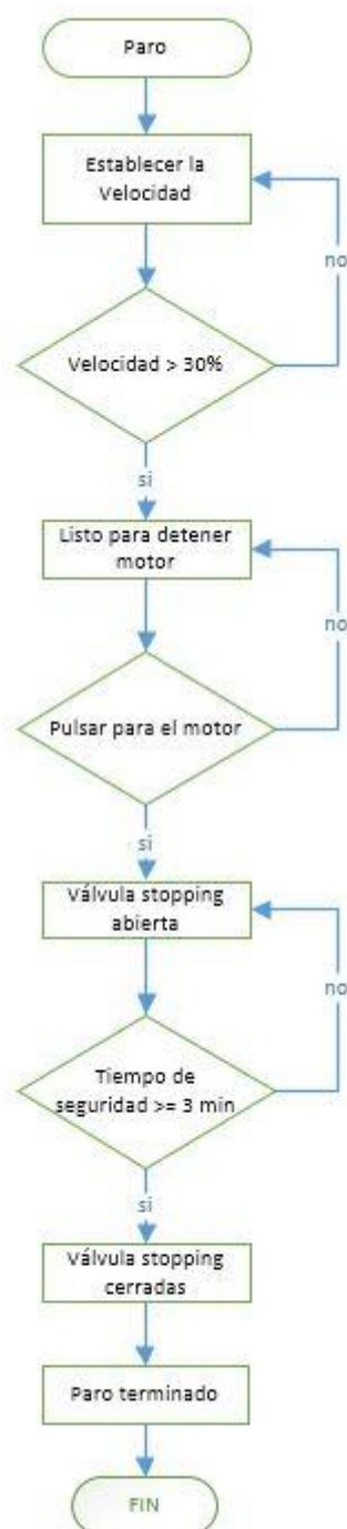
**Figura. 35** Diagrama de flujo del proceso de parada del motor generador.
