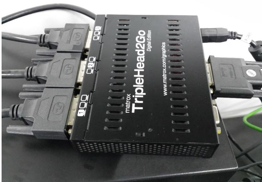
**Figura. 117** Tarjeta Matrox TripleHead2G.
