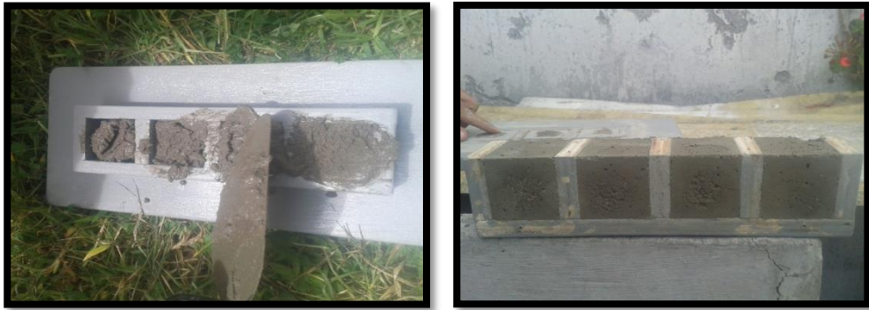
Figura 27. Proceso para la elaboración de las probetas a compresión
