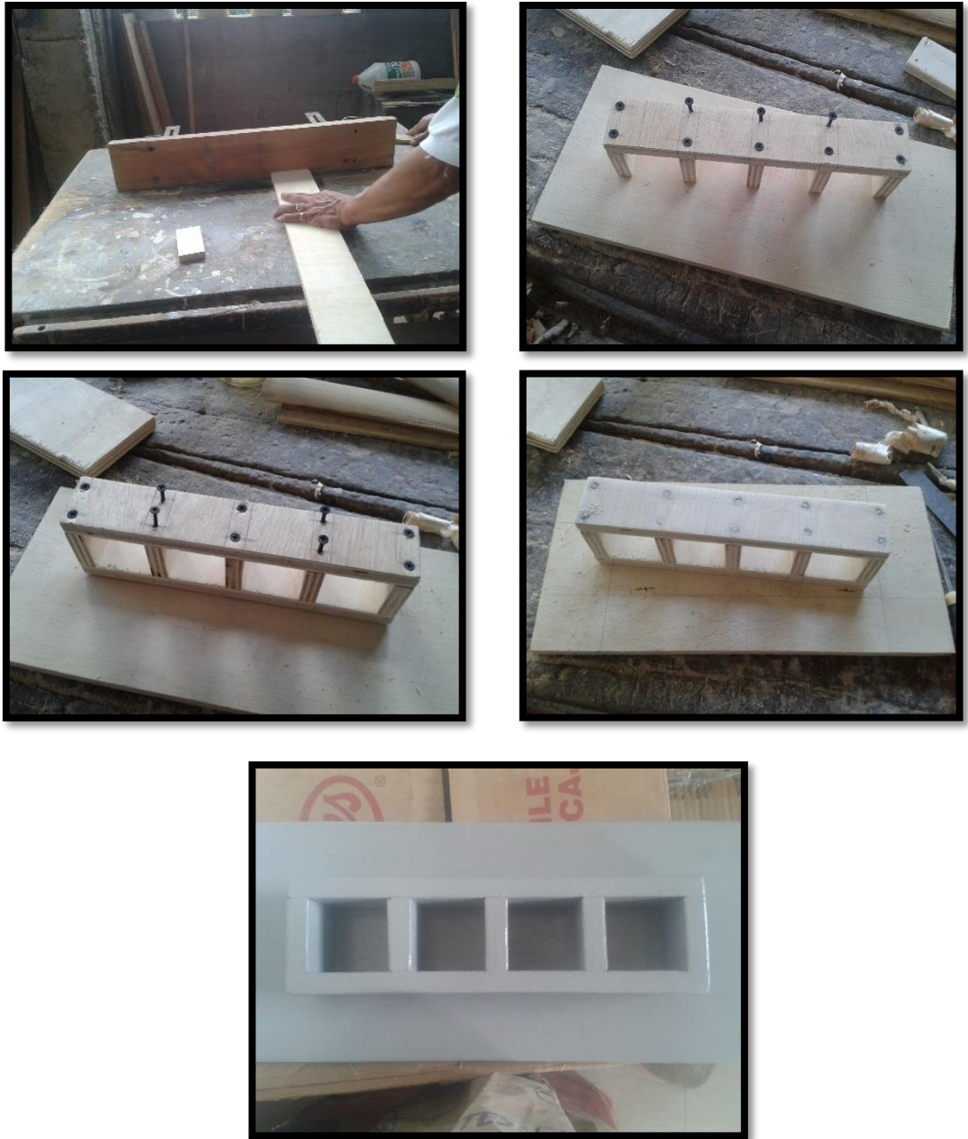
Figura 22. Proceso para la elaboración del molde para ensayos de compresión
