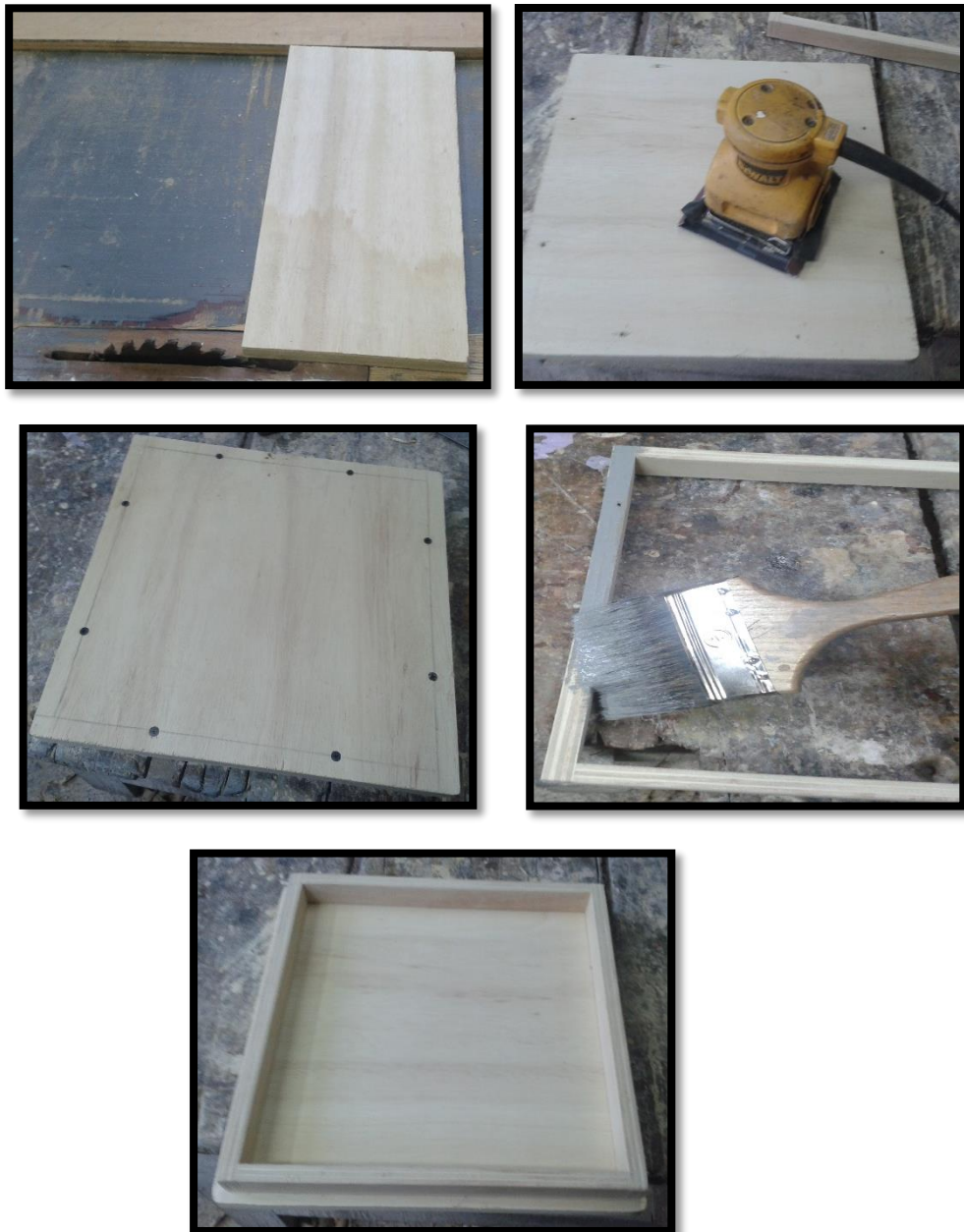
Figura 24. Proceso para la elaboración del molde para ensayos de flexión
