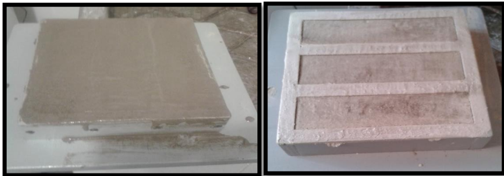
Figura 27. Proceso para la elaboración de las probetas a compresión
