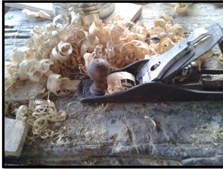
Figura 18. Obtención de fibras con cepillo manual de carpintería
