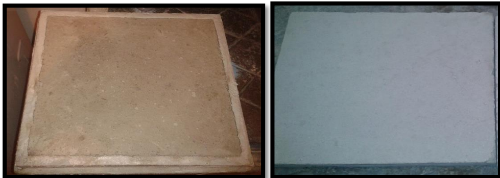
Figura 29. Proceso para la elaboración de las probetas para ensayos de conductividad térmica
