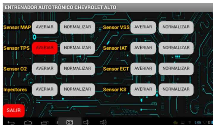
**Figura 90. Simulación de falla en el sensor TPS**
