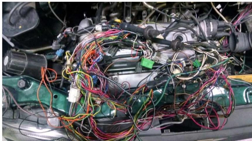
**Figura 66. Mazo de Cables Eléctricos mal configurados**
