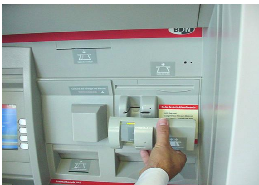
Figura 2. Delincuente coloca una ranura adicional en el cajero
