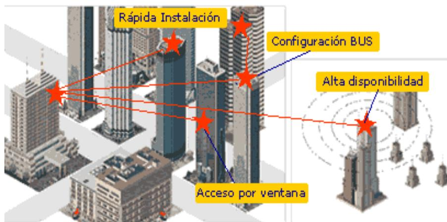
Figura 2.54: Aplicación de una red FSO en un ISP <sup>1</sup>
