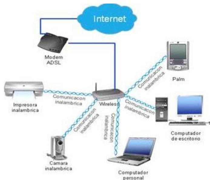
**Figura 2.39:** Diseño de un Red Inalámbrica<sup>1</sup>
