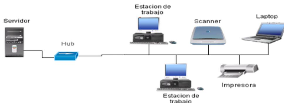
Figura 2.34: Ejemplo de una red en topología bus<sup>1</sup>
