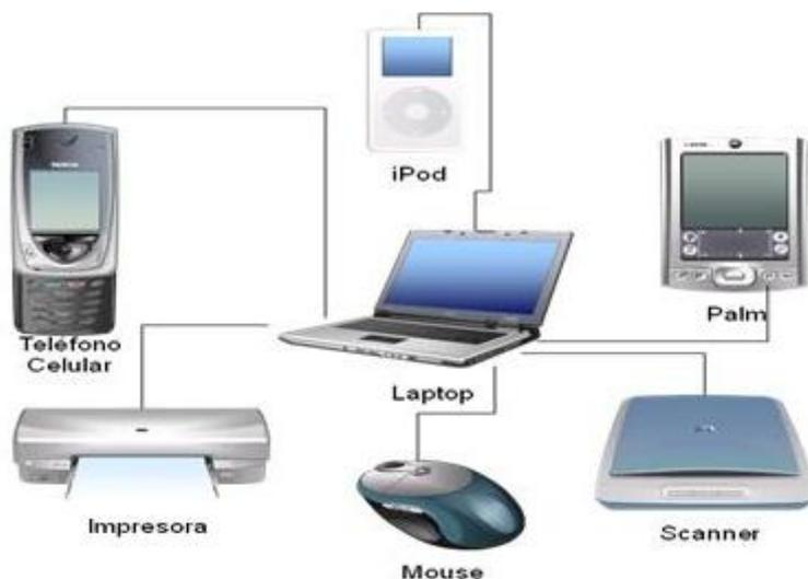
Figura 2.29: Ejemplo de una red PAN <sup>2</sup>
