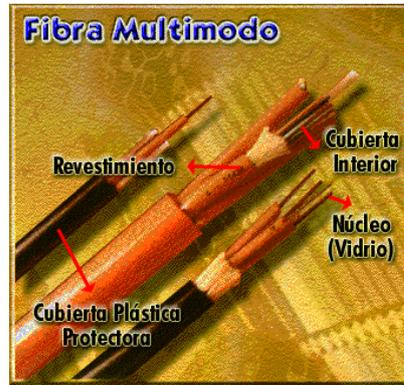
Figura 2.10: Estructura de un cable de fibra óptica multimodo<sup>1</sup>
