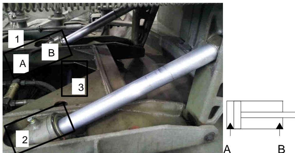
**Figura 2-27. Cilindros hidráulicos del Sistema de Recarga:**
