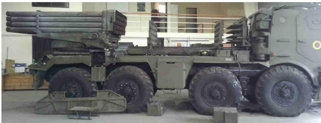
**Figura 2-22. Recargadora del RM-70 lista para la recarga, y Posición Abajo (VIII)**
