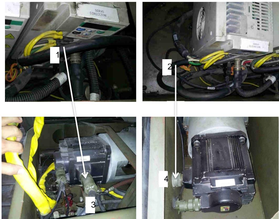
Figura 2-7. Conexión del Servo Drive a su respectivo Servo Motor (1-3; 2-4)
