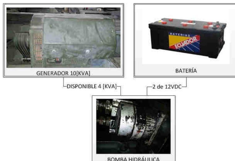
**Figura 3-5. Posibles fuentes de energía para la bomba hidráulica de accionamiento eléctrico**
