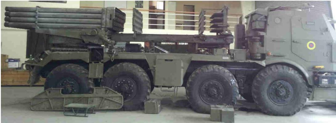
**Figura 2-23. Posición Arriba (V) y Posición Retroceso (VII) de la recargadora del RM-70**
