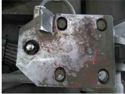
**Figura 2-40. Limitador de posición C23 en el Sistema de Recarga**
