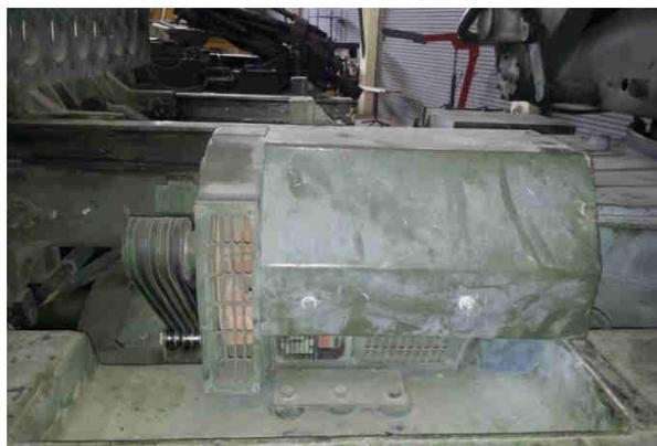
**Figura 2-9. Generador STAMFORD para los controladores de posicionamiento**
