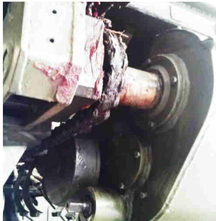
**Figura 2-38. Caja de transmisión de potencia conectada a cadena tipo rodillo**
