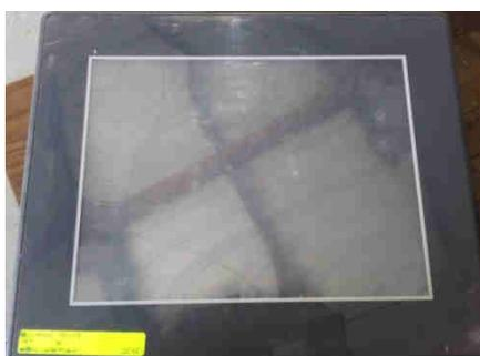
Figura 4-15. Pantalla táctil EA7-T12C como panel de control
