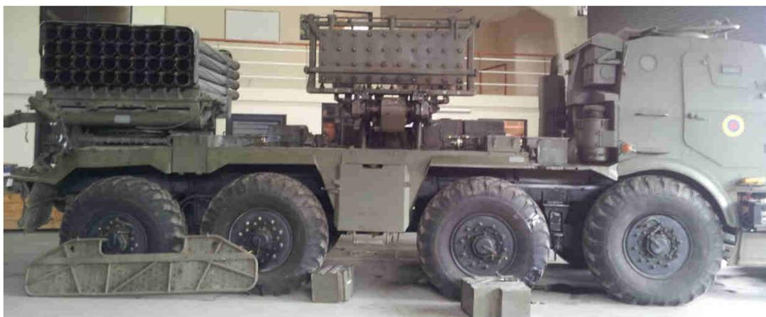
**Figura 2-21. Posición -90° (II) de la recargadora del RM-70**
