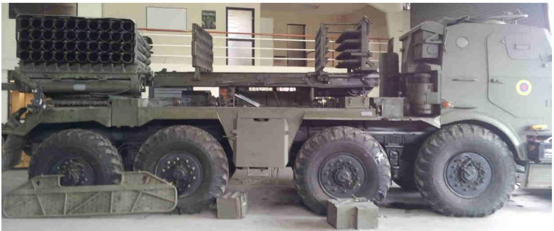
Figura 2-20. Posición Arriba (I) y Posición  $0^\circ$  (III) de la recargadora del RM-70
