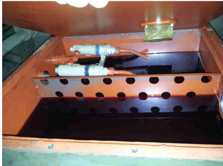
**Figura 2-32. Reservorio de aceite del sistema de recarga**
