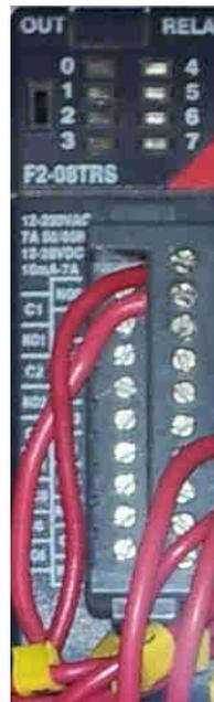
**Figura 4-3. Módulo F2-08TRS para las electroválvulas**
