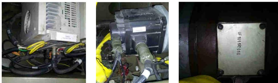
Figura 2-6. Servo driver (Izquierda), servo motor (Centro), y reductor (Derecha) de elevación del RM-70
