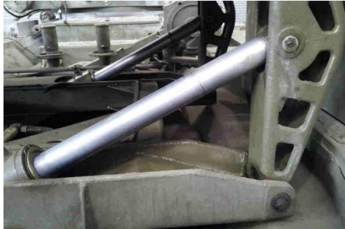
**Figura 2-28. Articulación para elevación de la recargadora**
