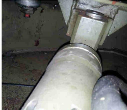
**Figura 2-29. Caja hidráulica de transmisión de movimiento para giro**
