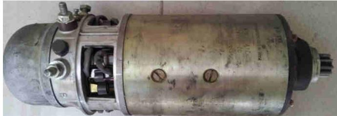
**Figura 2-35. Motor DC Magneton de la recargadora**
