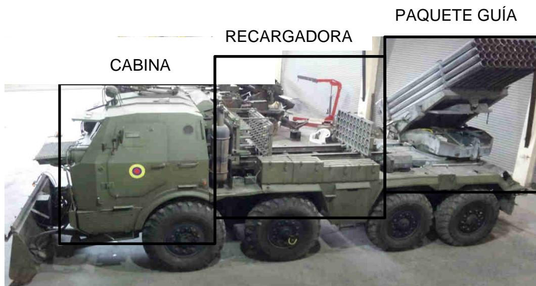
Figura 2-1. Vehículo RM-70 dividido en secciones
