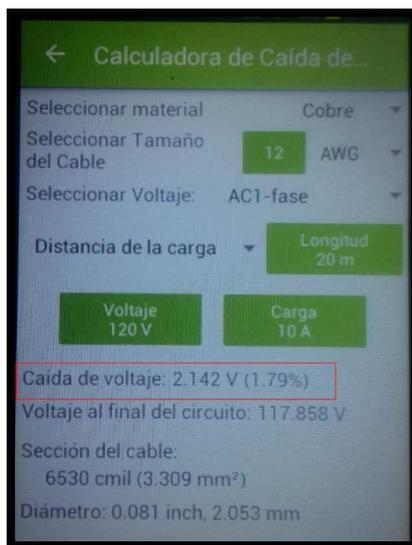
**Figura 67 Caída de tensión de luminarias y letreros de salida**
