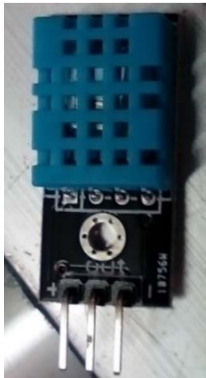
Figura 16.- Sensor de humedad y temperatura.
