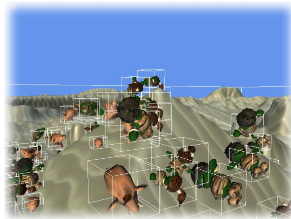
Figura 63. (Detección de colisiones en base a figuras geométricas)
