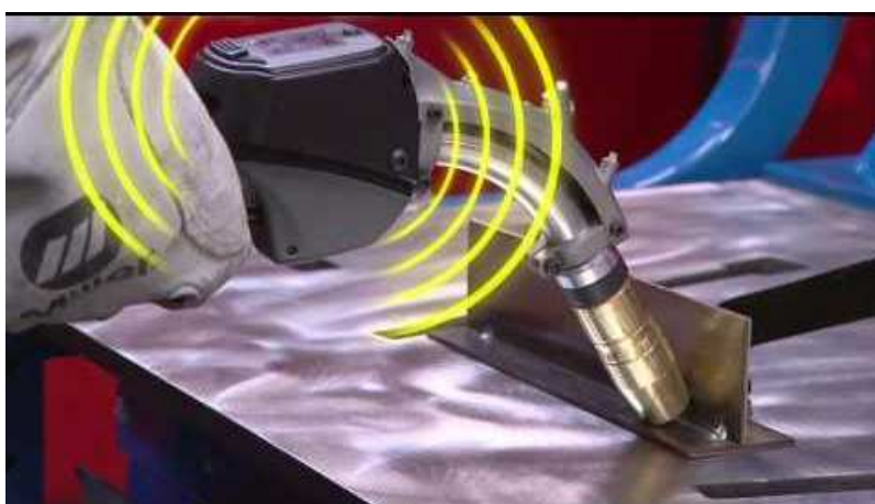
Figura 2. Pistola inteligente rango de trabajo 400 Amp (Miller, 2014)
