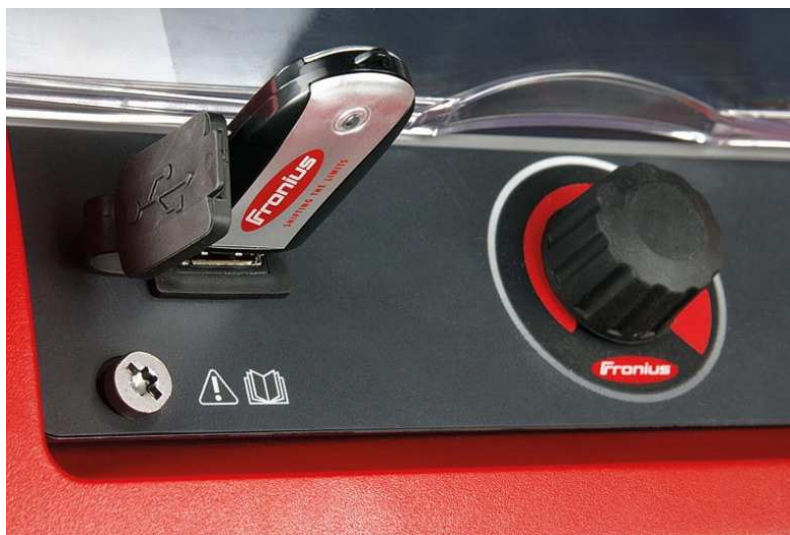
Figura 8. Módulo de actualizaciones portátil de la Fronius TPS7i Intelligent Revolution
