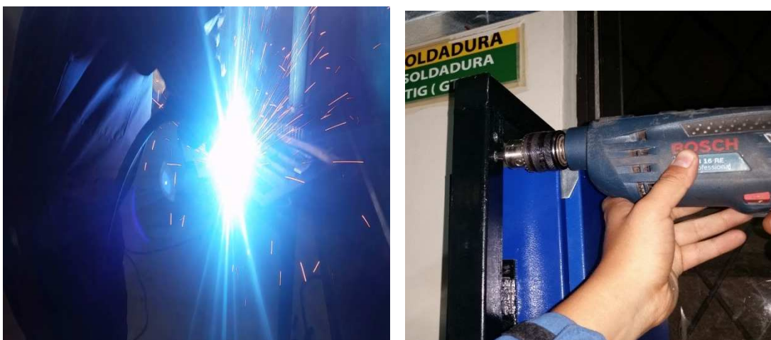
Figura 78. Conjunto de fotos donde se muestra los procesos de ensamble soldado y taladrado
