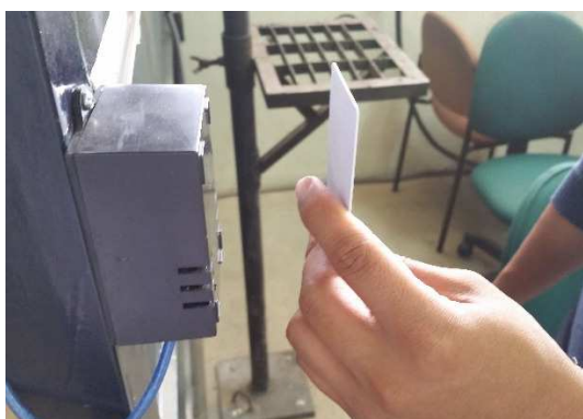
Figura 81. Uso de la tarjeta, sobre el módulo RFID
