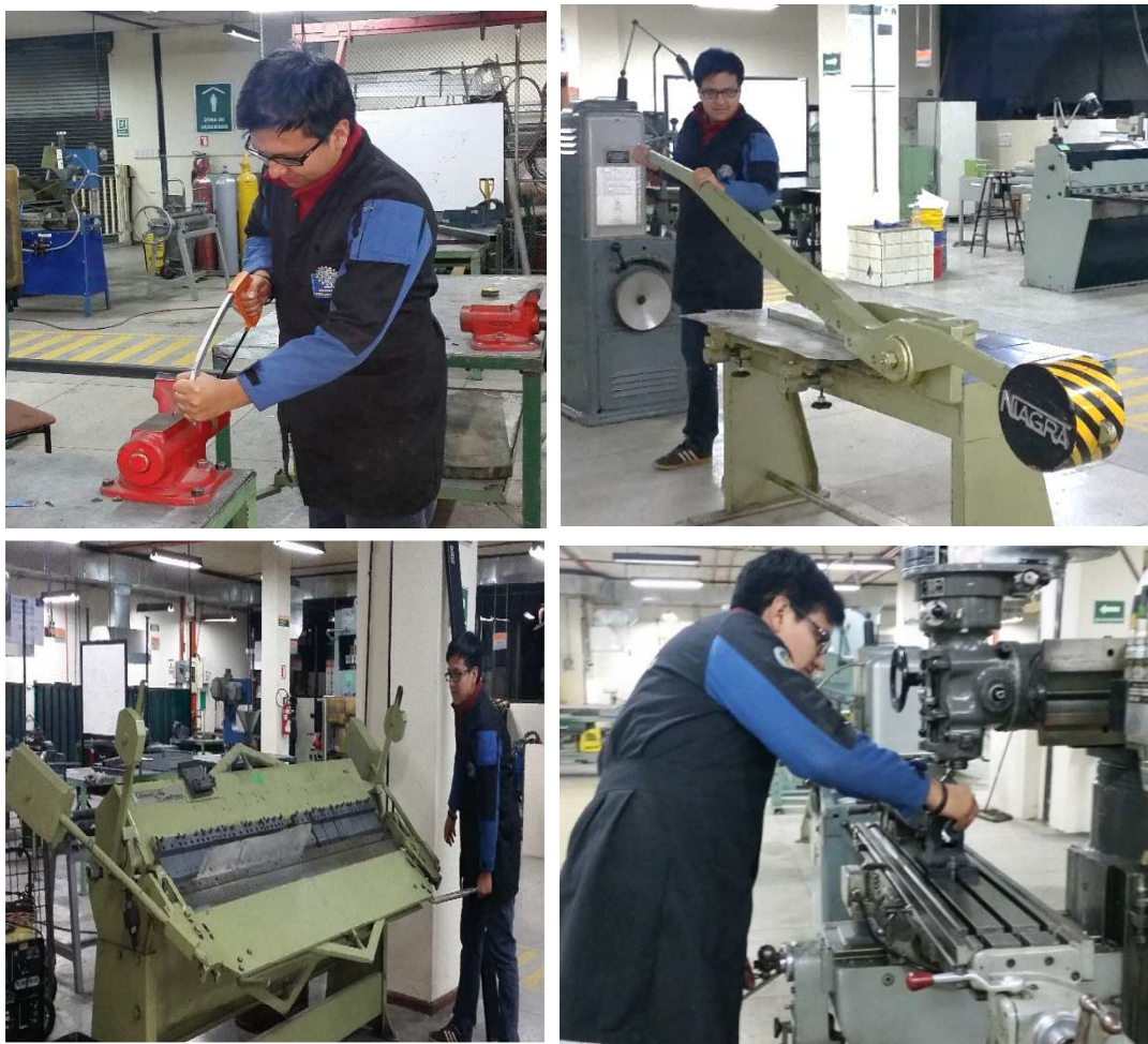
Figura 77. Conjunto de fotos donde se observa los procesos de maquinado iniciales; cortado, fresado, doblado.
