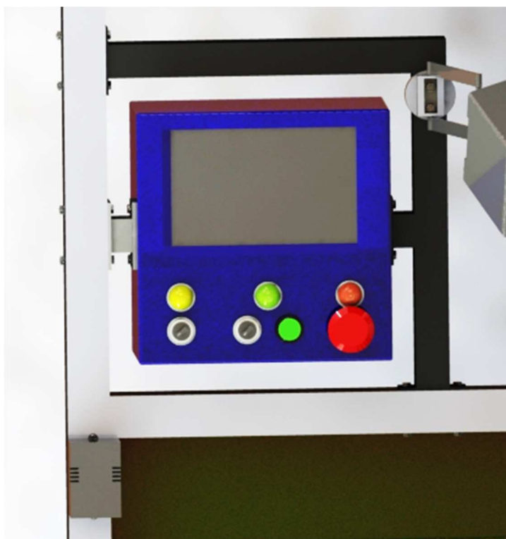
Figura 55. Módulo RFID bajo el panel de control
