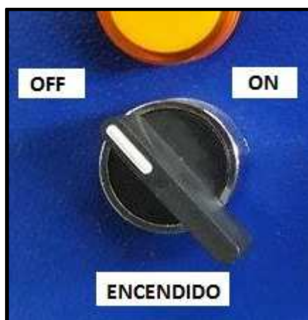
Figura 126. Interruptor de encendido del sistema apagado
