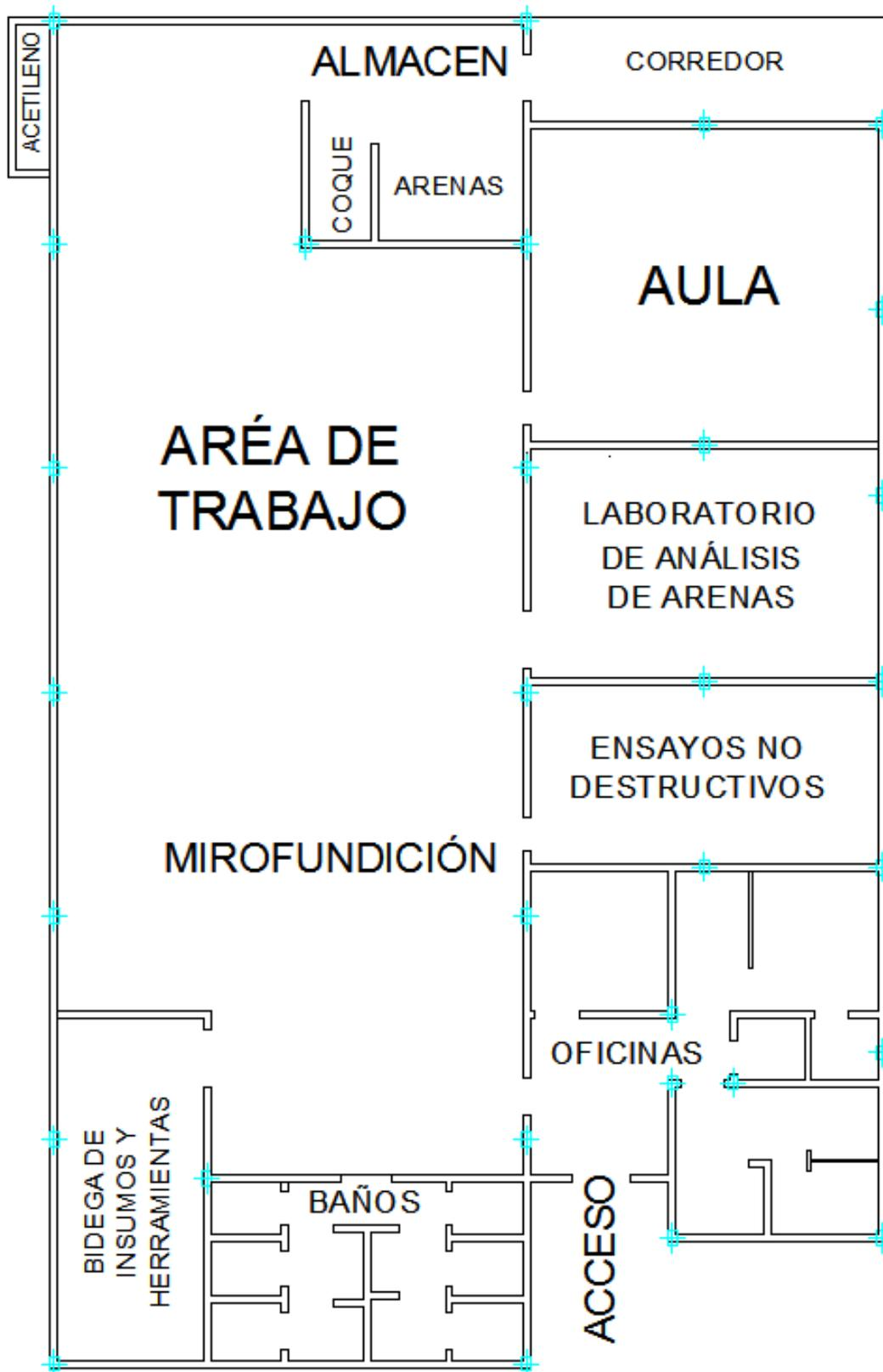
**Fig. 4.3.- Esquema de la distribución de planta del Laboratorio de Fundición**
