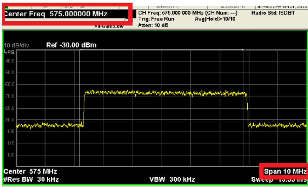
Figura 4.17: Verificación de ancho de banda
