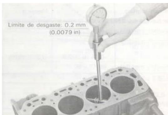
Figura 8 Medición tolerancias bloque de cilindros.
