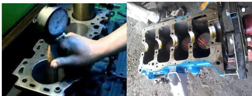
Figura 43 Medición del desgaste de los cilindros
