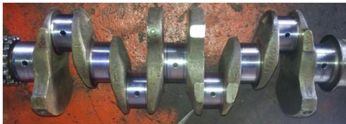
Figura 14 Cigüeñal en condiciones optimas
