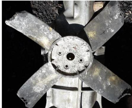
Figura 22 Ventilador averiado.
