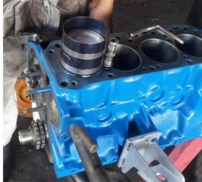
Figura 52 Ingreso de los pistones al bloque de cilindros.
