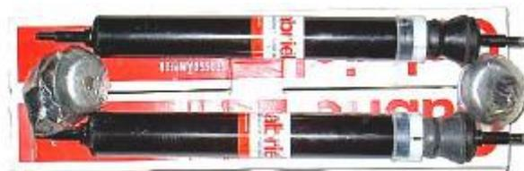
Figura 47 Amortiguadores traseros del automóvil 120Y.
