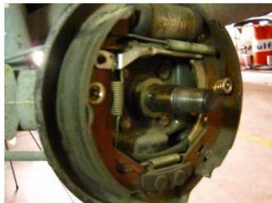
Figura 59 Sistema de freno de zapata.
