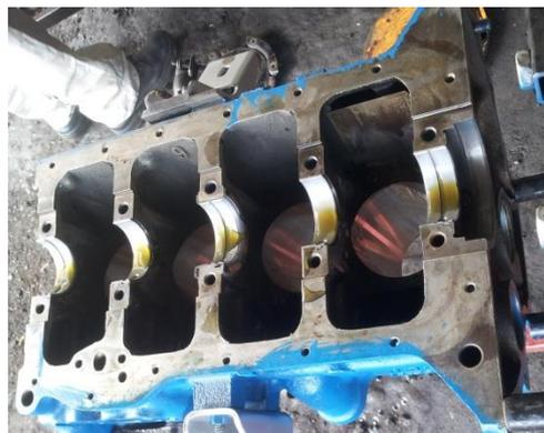
Figura 49 Bloque del motor listo para armar.
