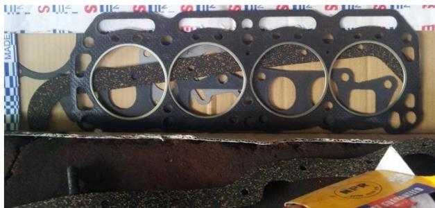
Figura 55 Kit de empaques para el motor.
