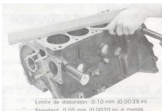
Figura 7 Defectación bloque de cilindros.
