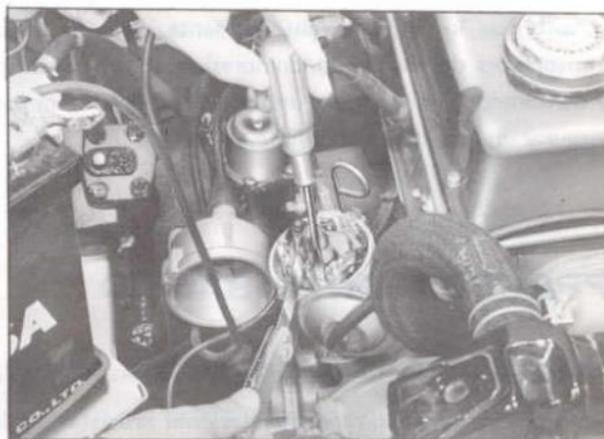
Figura 79 Comprobación de la separación de las puntas del distribuidor
