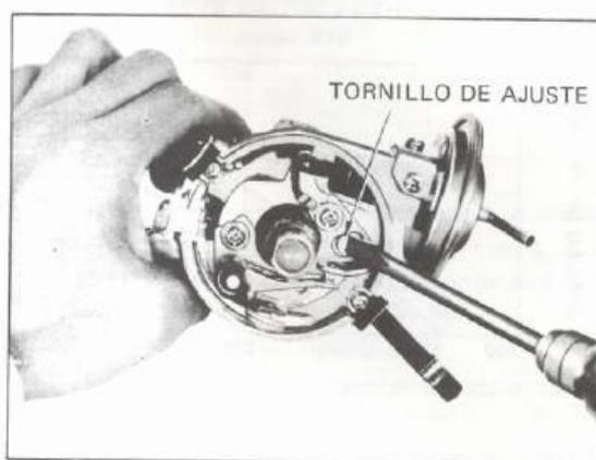
Figura 73 Ajuste de la separación de las puntas del distribuidor.
