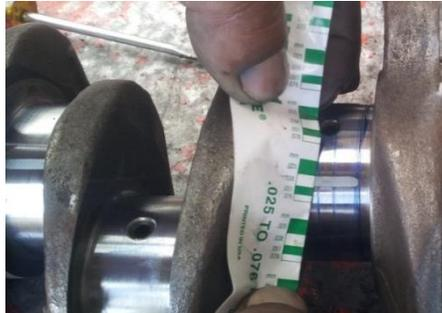
Figura 50 Ajustaje del cigüeñal mediante plastigage.
