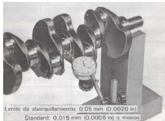
Figura. 15 Comprobación cilindridad
