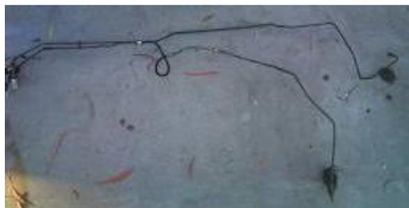
Figura 30 Cañerías del sistema de frenos.
