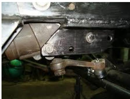
Figura 63 Barra de acoplamiento única
