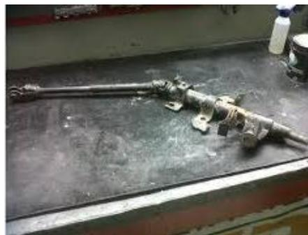
Figura 65 Columna de la dirección
