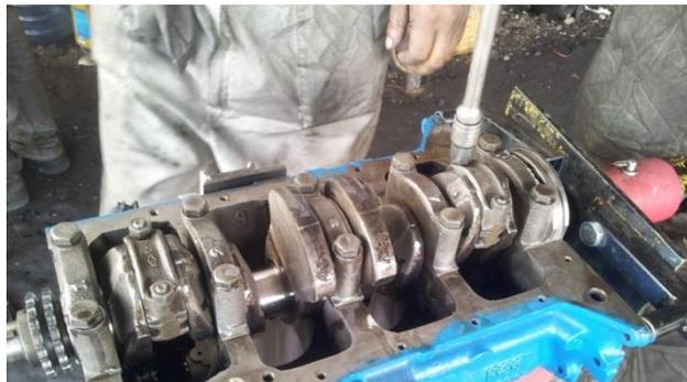
Figura 53 Ajuste de las tapas de las biela al cigüeñal.
