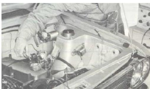
Figura 81 Ajuste en vacío del carburador
