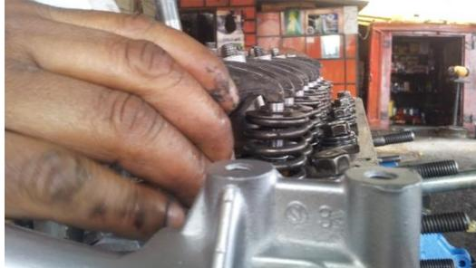
Figura 56 Balancines de válvulas.
