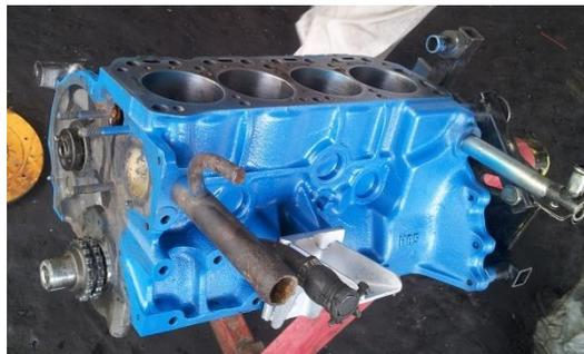
Figura 54 Bloque del motor instalado en un bastidor.
