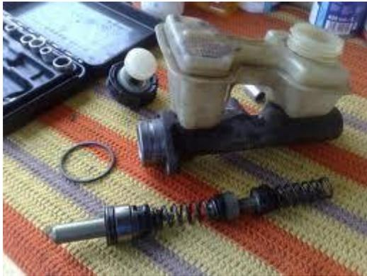
Figura 31 Bomba de frenos.
