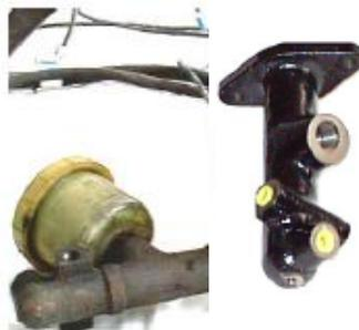
Figura 61 Bomba de frenos.
