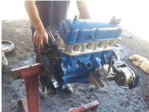
Figura 57 motor armado y listo para ser montado en el vehículo.
