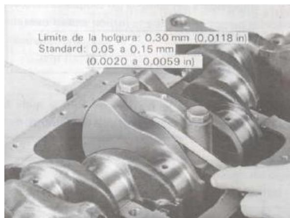
Figura 16 Comprobación excentricidad del cigüeñal.
