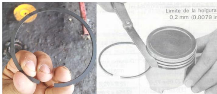
Figura 11 Anillos con desgaste
