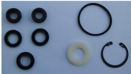
Figura 32 Juego de empaques de la bomba de frenos.
