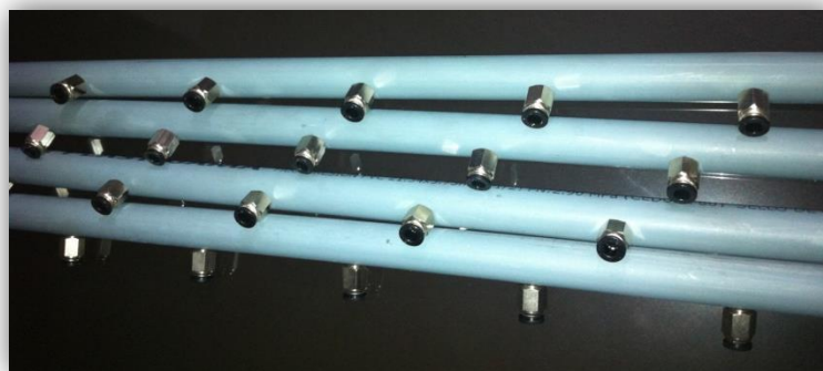
Figura 24. Tubos distribuidores de aire tipo flauta
