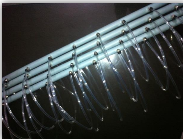
Figura 32. Tubos para distribución de aire tipo flauta implementados
