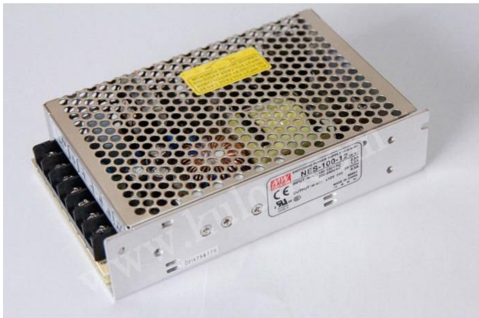
Figura 5.15 Fuente de 24voltios Utilizada para el sistema de motores
