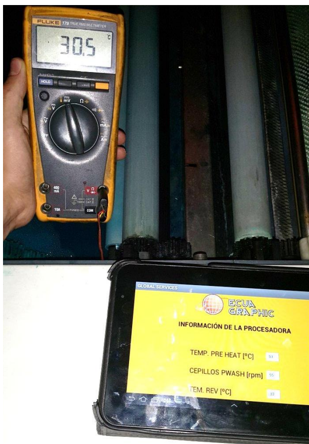
Figura 7.2 Prueba de temperatura del sistema de Revelado
