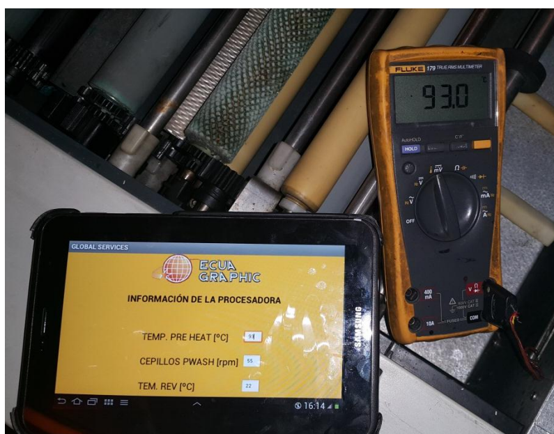
Figura 7.1 Prueba de temperatura del sistema Pre Heat
