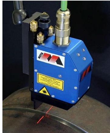
Figura 1.10 Sensor laser inteligente SLS-050.
