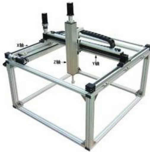
Figura 1.3: Sistema de movimiento cartesiano. (Wuxi Xinje Corporation, 2014)
