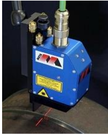
Figura 1.7: Seguimiento de junta mediante laser. (Meta Vision Systems Ltd, 2009)
