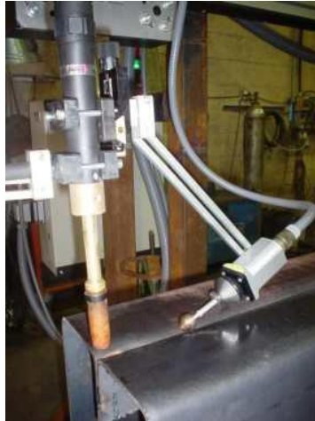
Figura 1.6: Seguimiento de junta mediante palpador. (Carpano, 2014)
