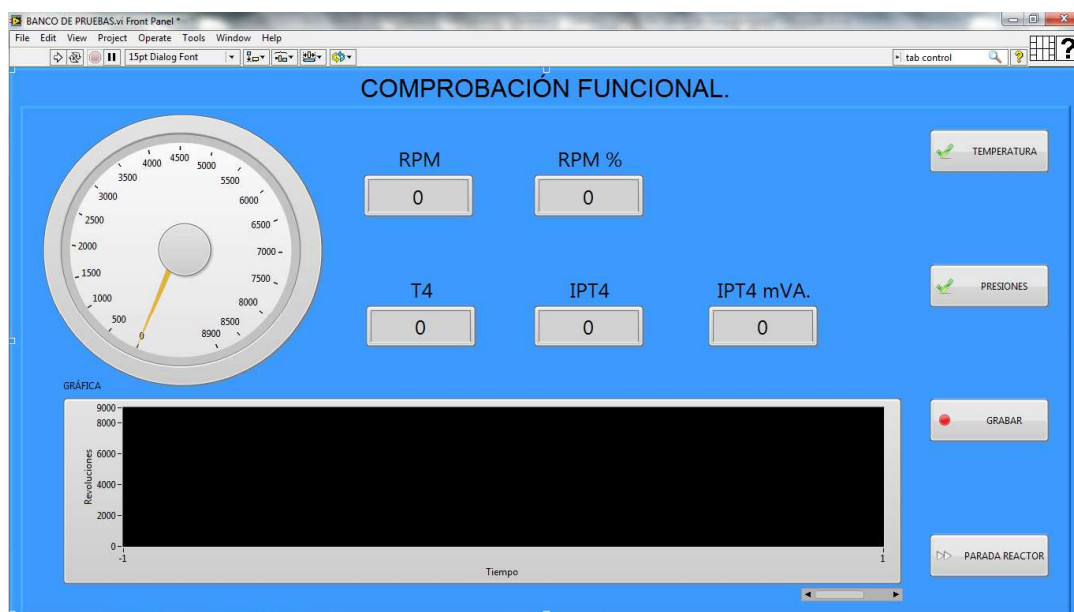
Figura 54. Panel Frontal de la Comprobación Funcional, sub ventana Régimen
