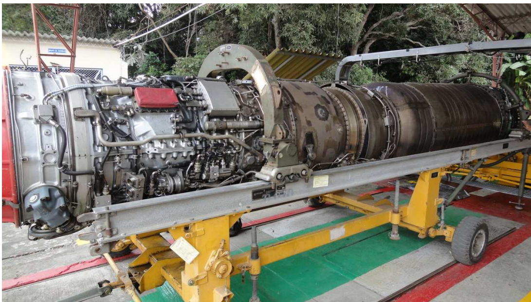
Figura 2. Motor Atar 09K50 versión c11.
