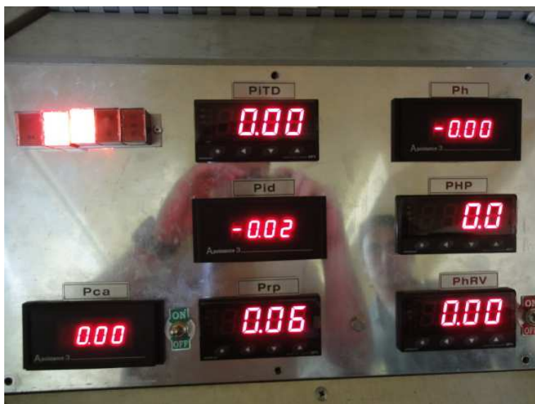
Figura 8. Indicadores de presión de combustible y aceite
