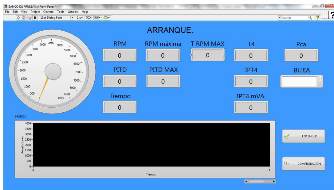
Figura 53. Panel Frontal del proceso de arranque
