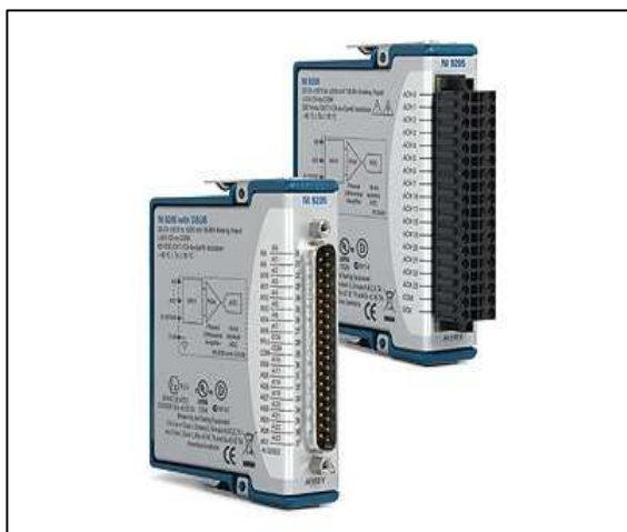
Figura 74. Módulo 9205 con los dos tipos de conector
