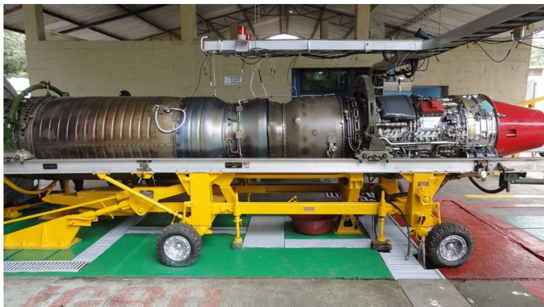
Figura 5. Motor instalado en el banco de pruebas
