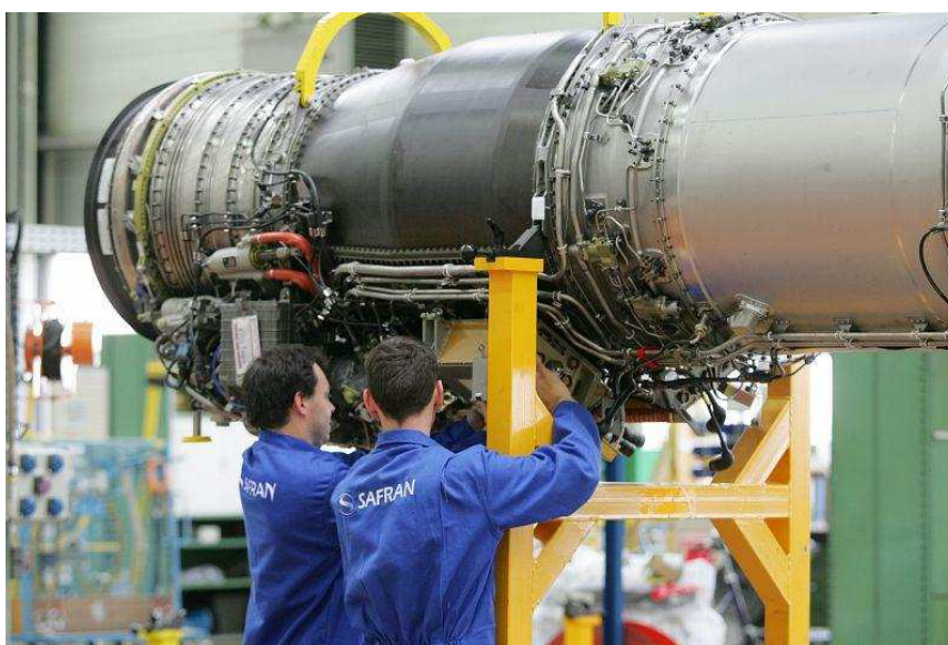
Figura 3. Trabajadores de Snecma en un motor M88
