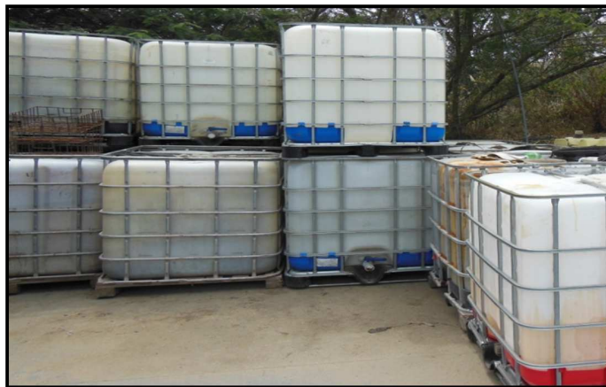
Figura 11: Almacenamiento Temporal de Lodos en Tanques Herméticos de 1\text{m}^3
