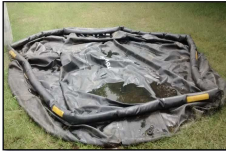
Figura 4: Berma utilizada para evitar Derrames de Aceite Usado
