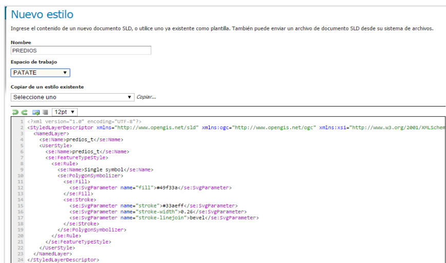
Figura 50. Carga de estilo SLD en Geoserver.
