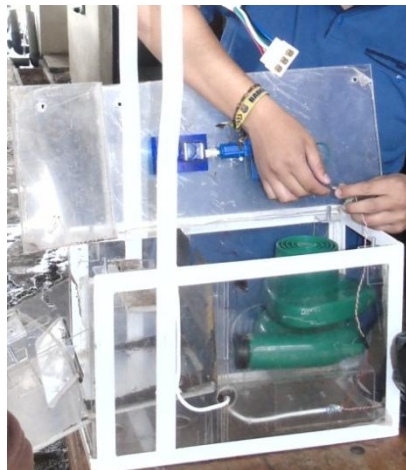
Figura 74. Desmontaje de la tapa y acceso a la parte interna del dispensador.
