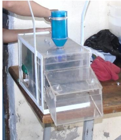
Figura 76. Montaje de la tapa superior del dispensador.
