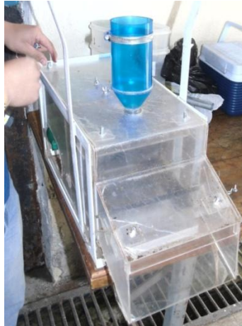
Figura 73. Desmontaje de la tapa superior del dispensador.
