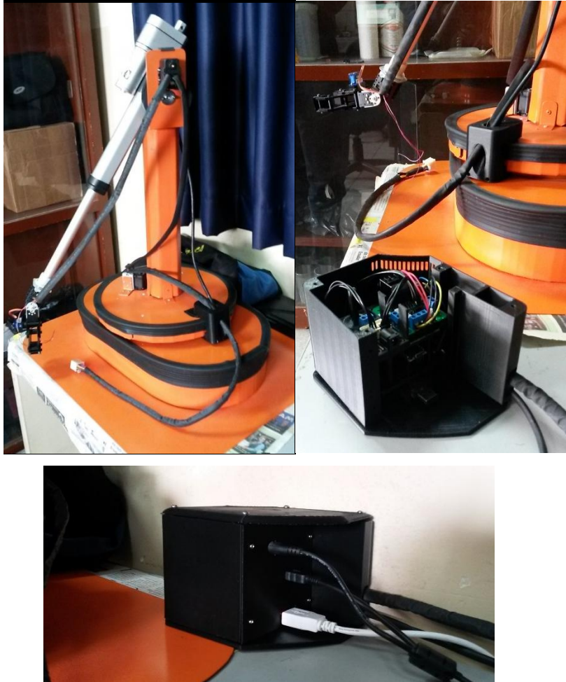
Figura 67. Cableado estructurado y caja elementos electrónicos
