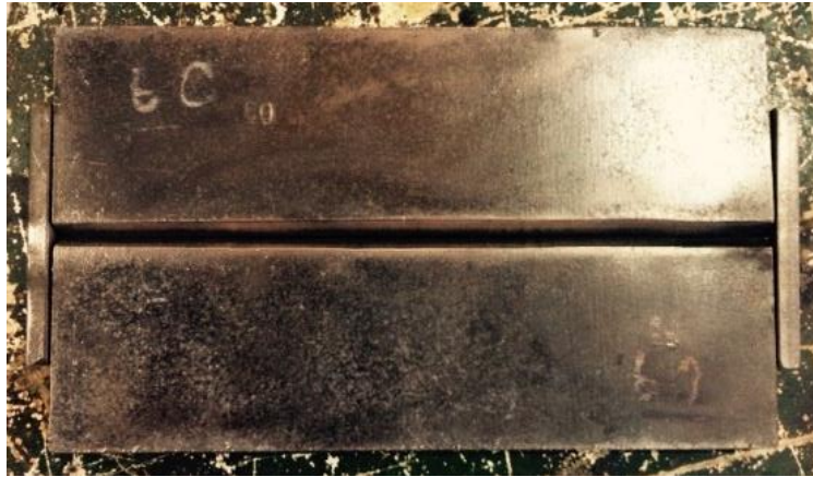
Figura 19 Unión PJP a tope rigidizada en los extremos
