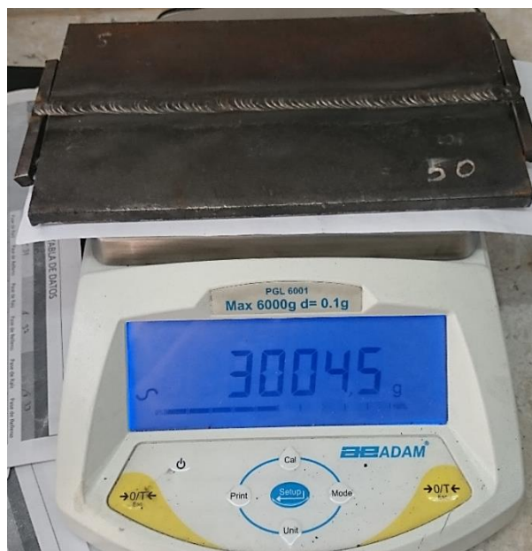
Figura 30 Pesaje final ya con el cordón de relleno
