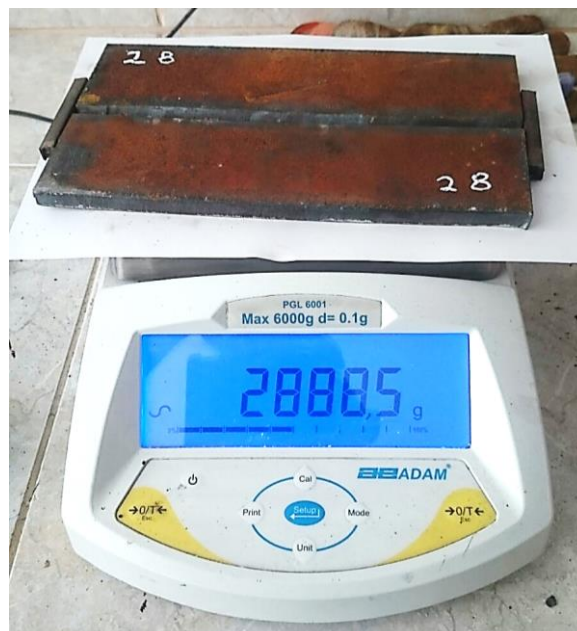
Figura 20 Pesaje de la unión sin soldar
