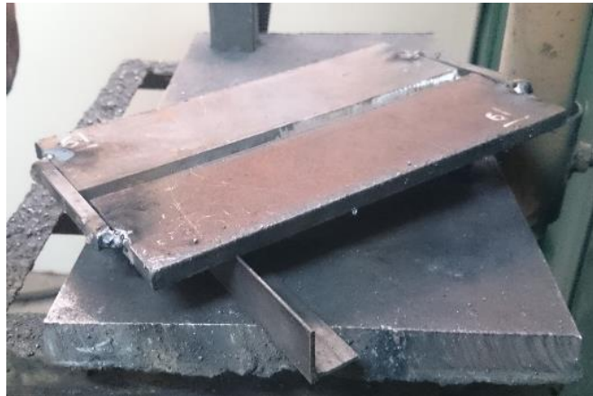
Figura 21 Unión posición 1G
