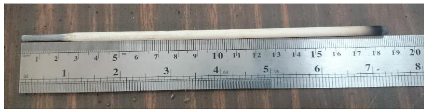
Figura 26 Medición del sobrante del último electrodo
