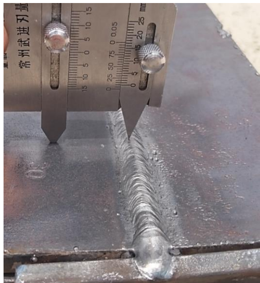
Figura 29 Medición del refuerzo mediante la galga
