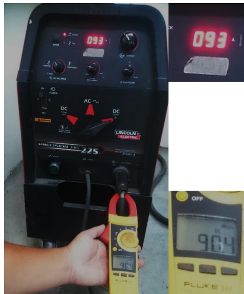
Figura 27 Comprobación de Amperaje
