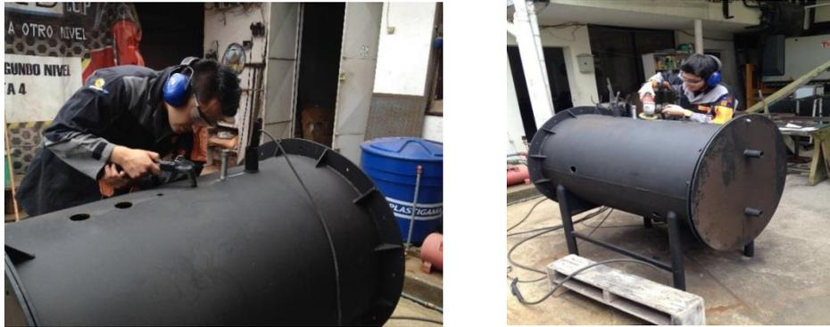
**Figura 65.-** Corte por plasma de aberturas y maquinado final.
