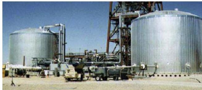
**Figura 19.-** Sistema de Almacenamiento de doble tanque.
