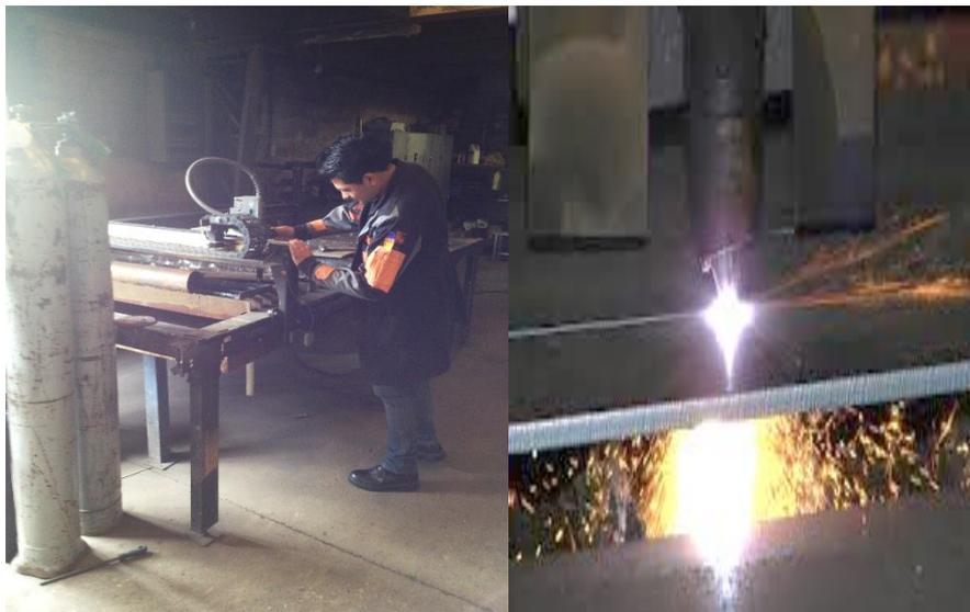
**Figura 60.-** Corte de lámina por oxicorte.
