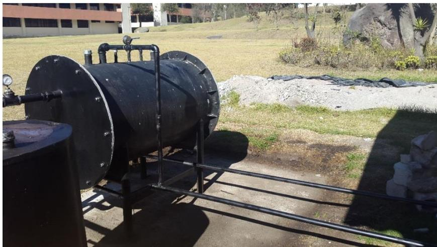
**Figura 71.-** Conexión del caldero con el intercambiador de calor.
