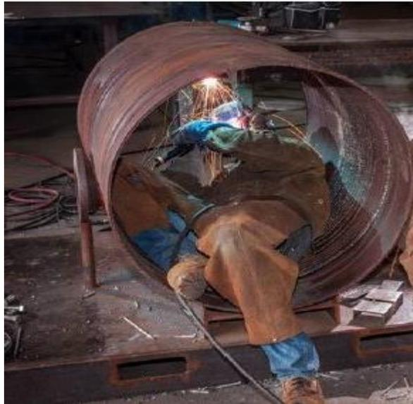
**Figura 62.-** Soldadura GMAW del cuerpo del cilindro.
