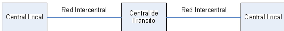
Figura A - 9.2 Conexión entre dos centrales
