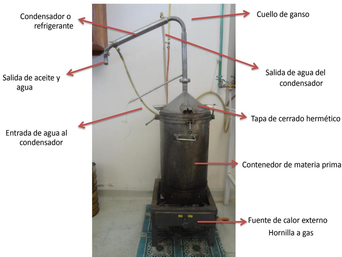
**Figura 23. Destilador utilizado en el proceso de extracción de aceites esenciales**
