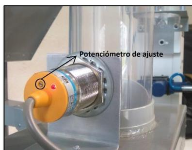
**Figura 2.21: Potenciómetro de ajuste del sensor capacitivo**
