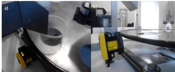
**Figura 2.40: Sensor Láser QS30LDL. a) detectando el recipiente. b) Sin detección**
