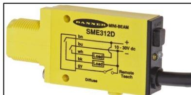
**Figura 2.57: Sensor fotoeléctrico banner mini beam SME312D**
