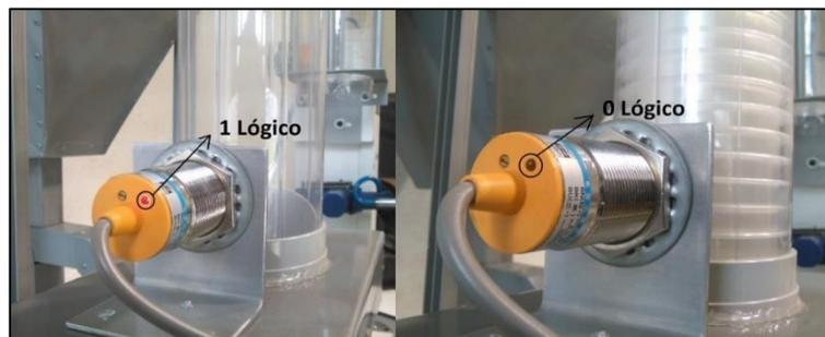
**Figura 2.20: Funcionamiento del sensor AMICO LJC30A3-H-z/AY en: a) 1 lógico. b) 0 lógico**
