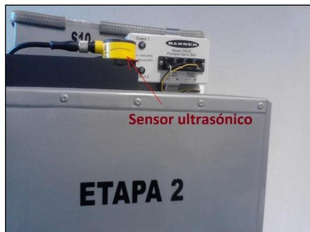
**Figura 2.43: Ubicación del sensor ultrasónico U-GAGE T30UIPAQ**
