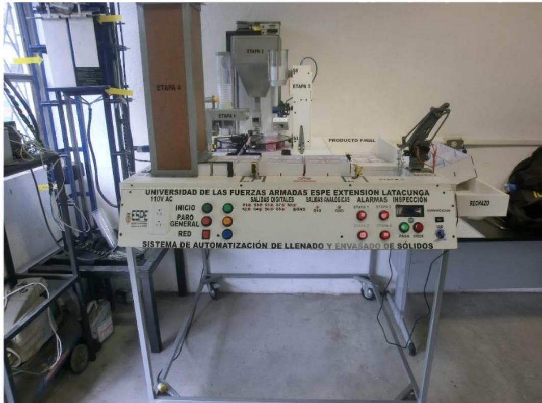
**Figura 2.70: Planta del módulo didáctico de llenado y envasado de sólidos**
