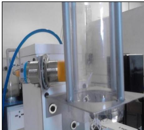
**Figura 2.51: Ubicación del sensor capacitivo AMICO LJC30A3-H-Z/AY**
