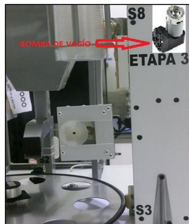
**Figura 2.53: Ubicación en la envasadora de la bomba de vacío**
