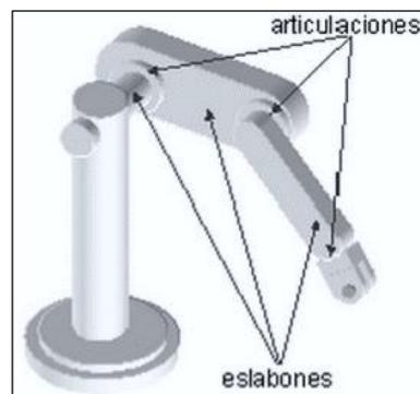
**Figura 1.7: Partes de un manipulador robótico**
