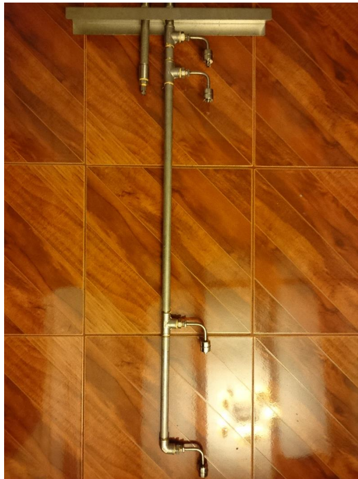
Figura 6.5: Controlador de nivel de agua para 500 [lt.]
