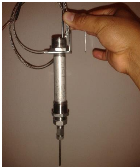
Figura 6.7: Sensor de temperatura tipo termocupla.
