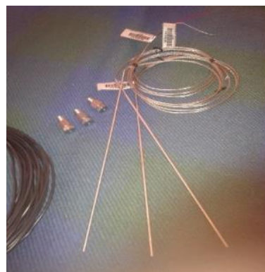
Figura 4.8: Accesorios y termocupla tipo J.
