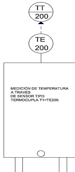
Figura 4.3: Medición de temperatura en el tanque de calentamiento de agua.
