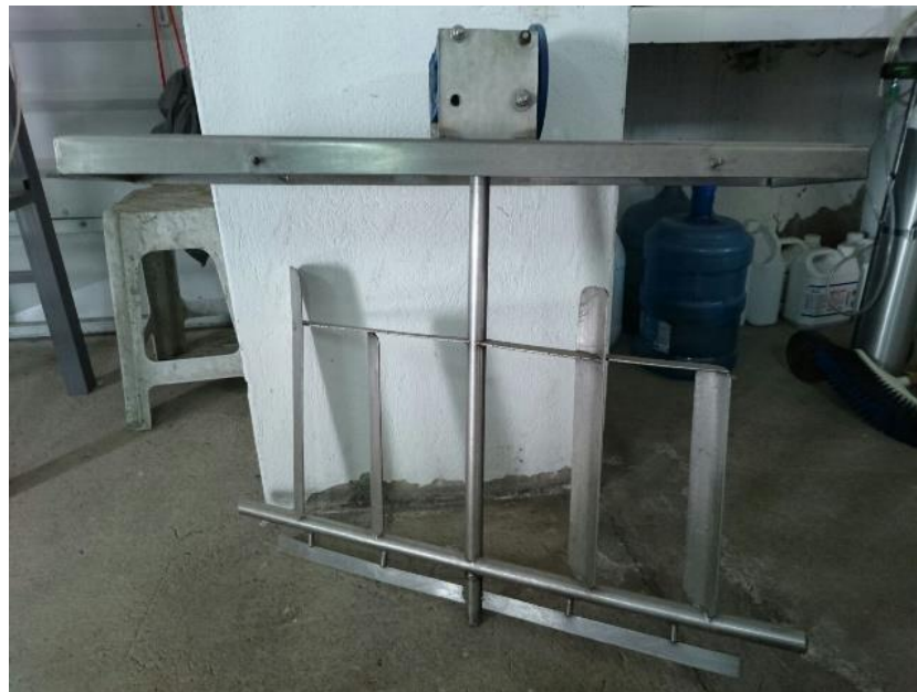
Figura 3.29: Agitador de paletas tipo reja
