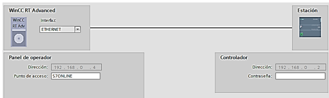
Figura 5.16: Comunicación HMI y PLC.
