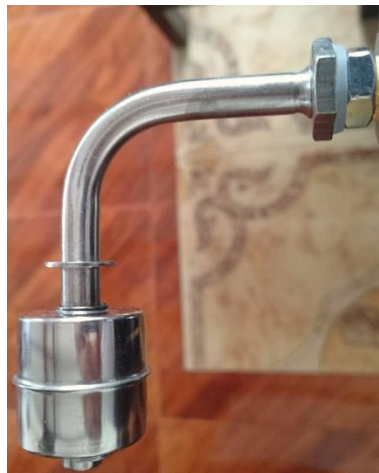
Figura 4.13: Sensor de nivel de flujo recto magnético.
