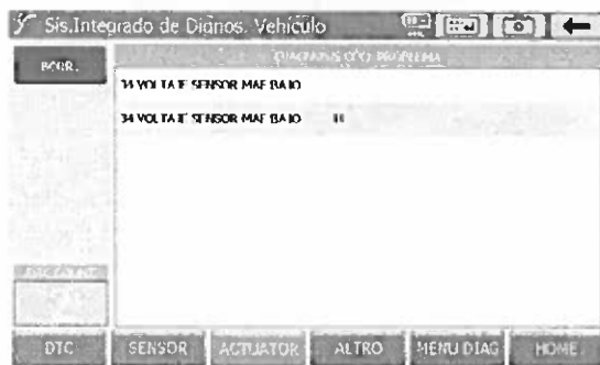
Figura 14 Pantalla de códigos de falla.
