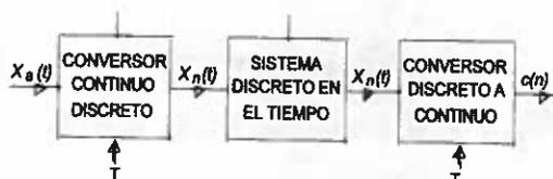
Fig. 2 Sistema básico para el filtrado discreto en el tiempo
