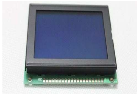
Figura 12. LCD Grafico 128x64 pixeles (Vishay, 2002)
