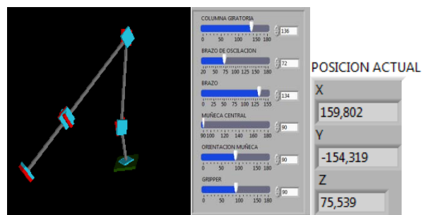
Fig.6. Cinemática directa del brazo robótico
