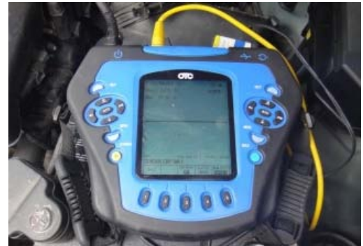
Fig. 11. Voltaje del conector de las válvulas solenoides
