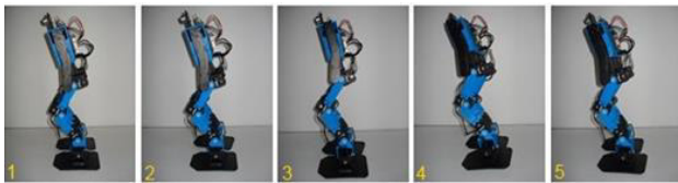
Figura. 14. Trayectorias del giro a la derecha del robot bípedo en el plano sagital.
