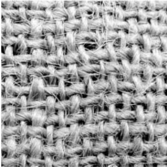
Fig. 2. Tejido empleado como refuerzo elaborado con la fibra natural de yute. Fuente: Los autores
