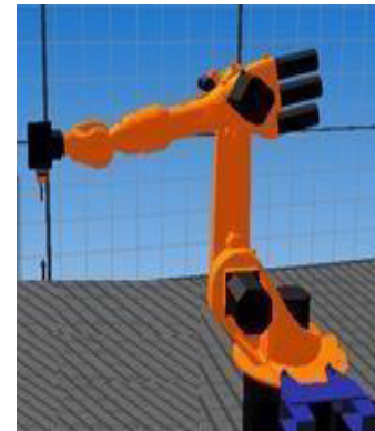
Fig. 6: Robot industrial KUKA KR16 con cabezal fresador adaptado en el KUKA Sim Pro.
