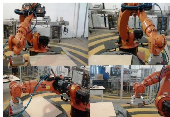
Fig. 2: Medición de alcance del Robot.
