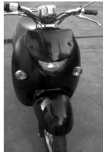
Figura 121 Colocación del carenado.
