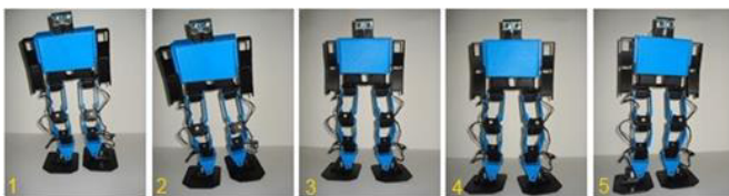
Figura. 17. Trayectorias del giro a la izquierda del robot bípedo en el plano frontal.
