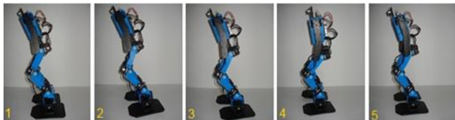
Figura. 16. Trayectorias del giro a la izquierda del robot bípedo en el plano sagital.
