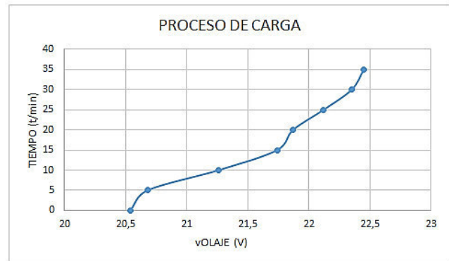
Fig. 16 Tensión pack 2-bloque 3 proceso de carga
