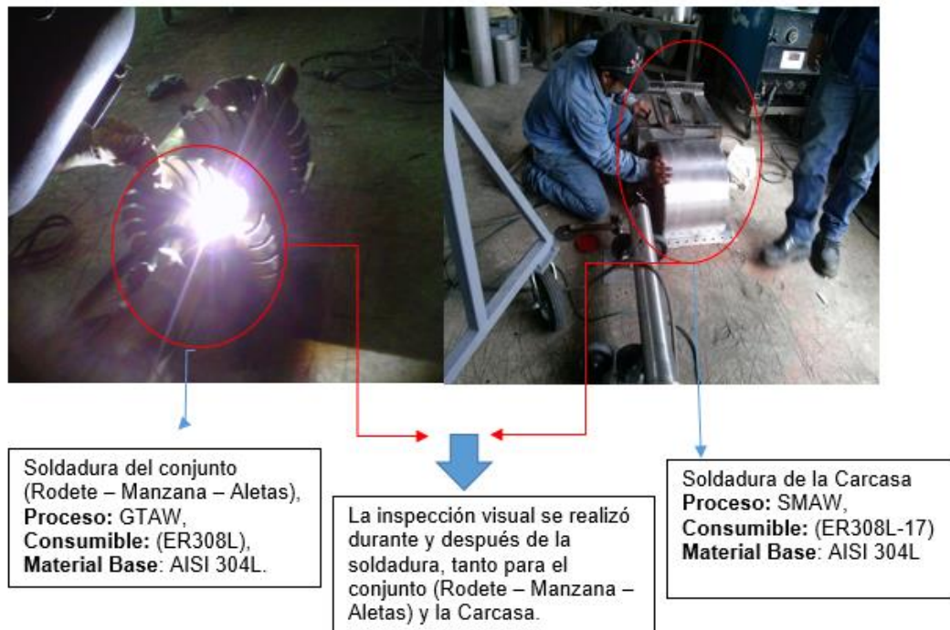
Figura 53: Proceso de Soldadura e inspección del Rodete, Manzana y Aletas.
