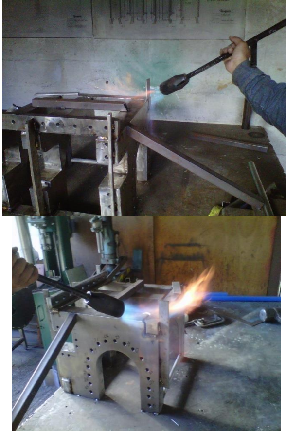
Figura 48: Precalentamiento del material base
