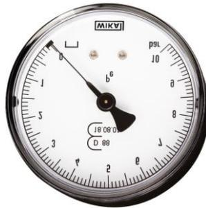
**Figura 13.** Indicador de presión tipo Bourdon.
