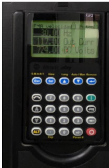
**Figura 94.** Prueba de arranque de motor en vacío. Verificación de parámetros
