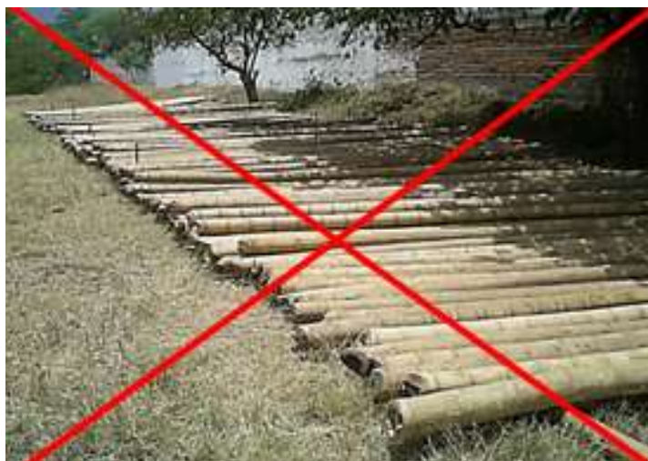
Figura 6.2. No se debe colocar directamente en el suelo la guadúa destinada para la construcción del puente peatonal de GAK (Stamm, 2010).
