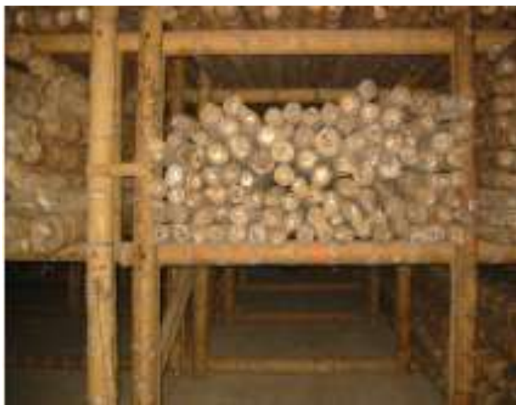
Figura 2.16. Técnica de curado en la mata. Culmos reposando bajo una cubierta seca y ventilada (Montoya, 2008)
