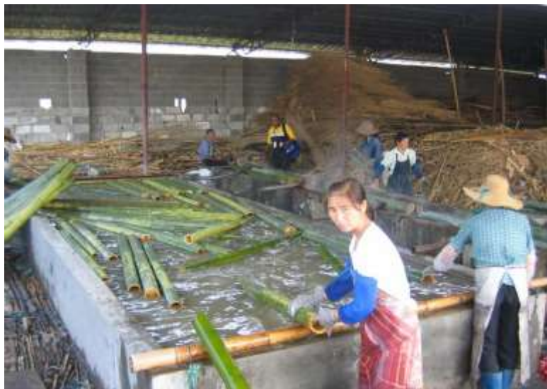
Figura 2.19. Curado por Inmersión con solución de ácido bórico y bórax (Londoño, 2002).
