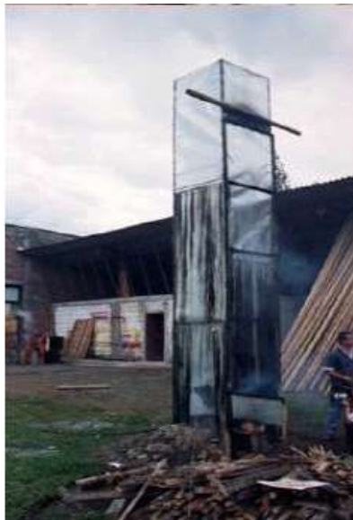
Figura 2.23. Horno Vertical para secado con humo (Tandazo & Flores, 2012).
