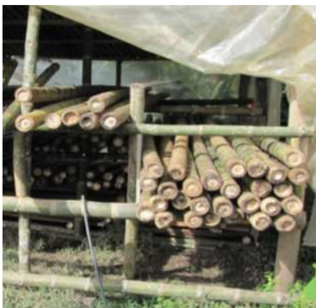
Figura 6.1. Colocación de la guadúa sobre un pedestal y bajo techo (Teneche, 2011).
