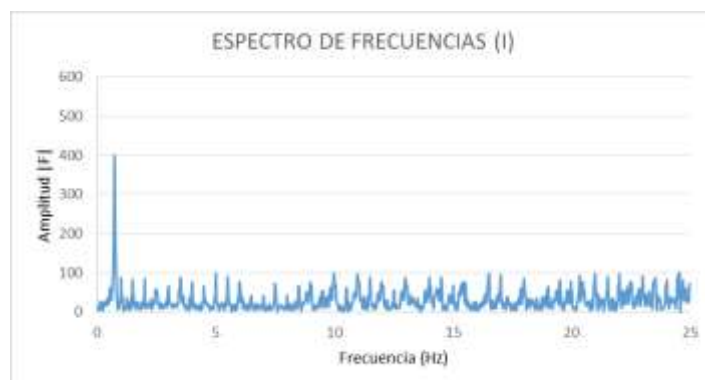
Figura 4.59 Espectro de frecuencia “I” carga dinámica cada 1.0 s.
