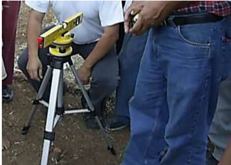
Figura 6.9. Nivel utilizado para alineación de cotas (Stamm, 2010).
