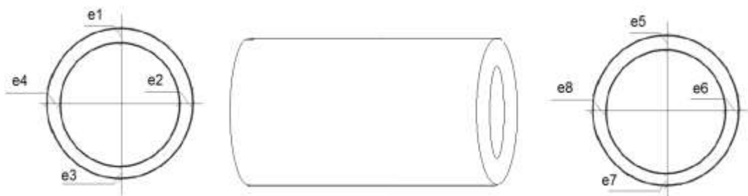
Figura 2.25. Espesores de la sección transversal (Cobos & León, 2007).
