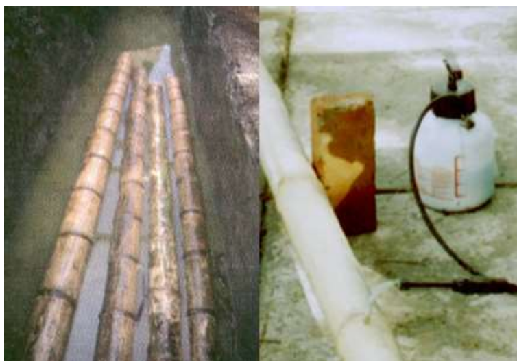
Figura 2.14. A la izquierda, culmos con conservantes ineficaces. A la derecha, químico tóxico para el ambiente (Londoño, 2002).
