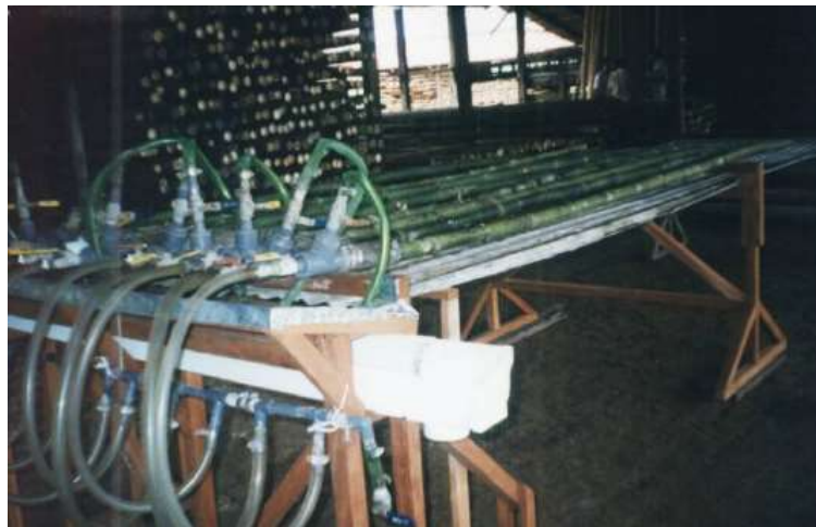
Figura 2.22. Método Boucherie modificado (Londoño, 2002).
