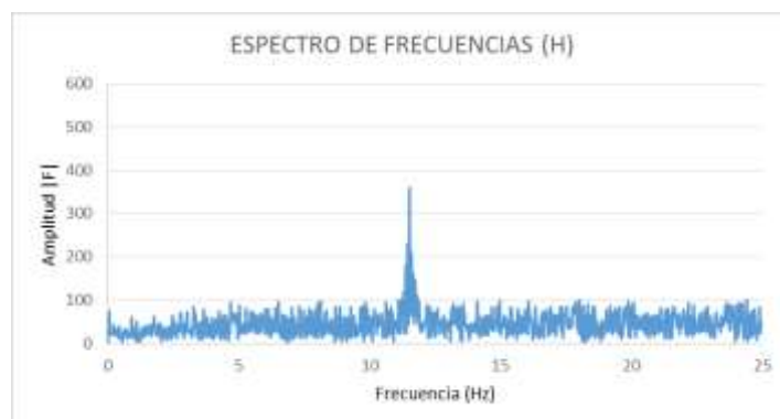
Figura 4.42 Espectro de frecuencia “H” carga estática y dinámica cada 0.5 s.
