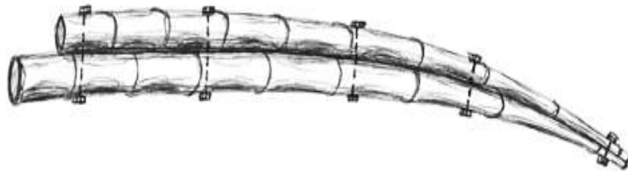
Figura 6.44. Curvatura natural de los culmos de guadúa para formar cerchas con vigas cargadoras (Stamm, 2000).
