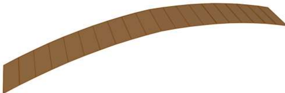
Figura 5.36. Elementos Shell del tablero en SAP2000.
