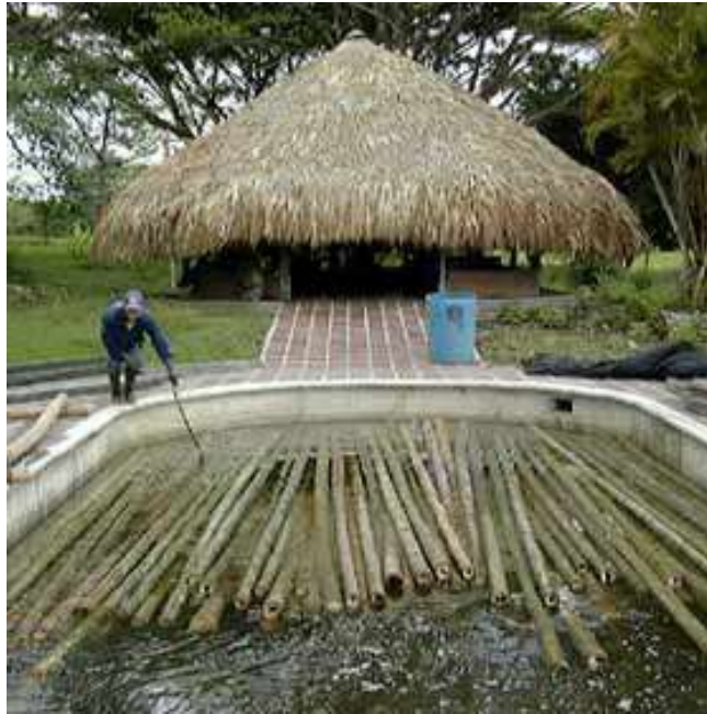
Figura 2.17. Curado por inmersión en agua (Silva, 2008).
