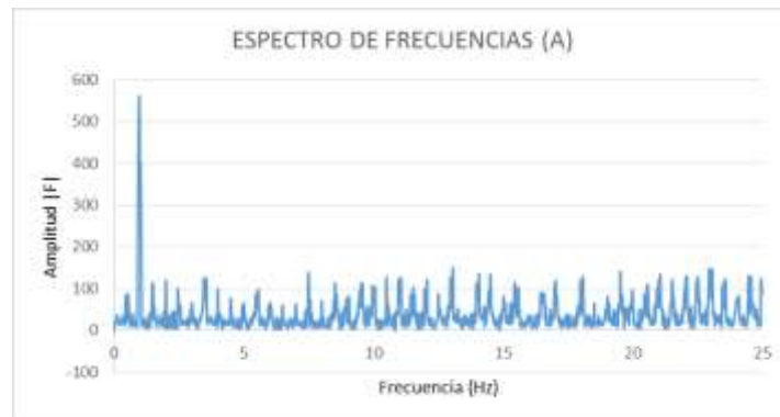
Figura 4.52 Espectro de frecuencia “A” carga dinámica cada 1.0 s.
