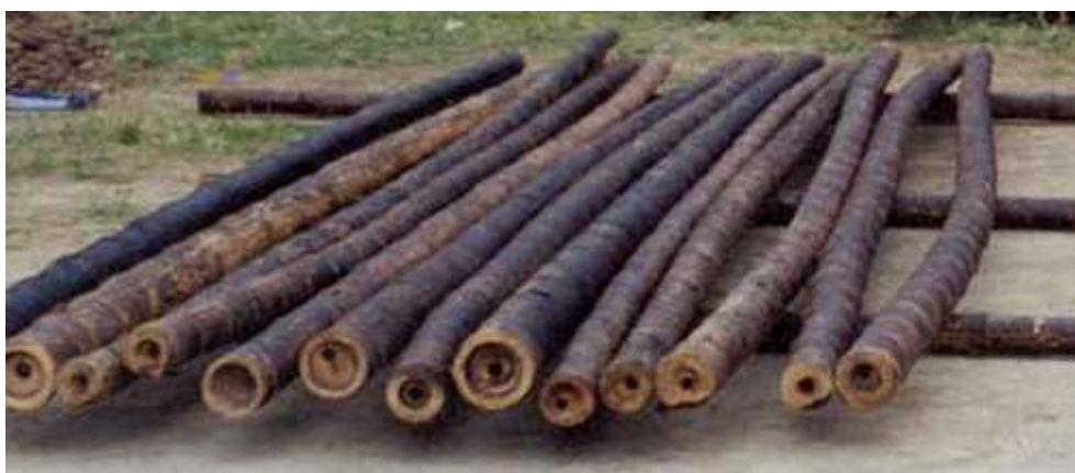
Figura 6.5. Categorización de guadúas, con una o más curvas (Stamm J. , 2010).
