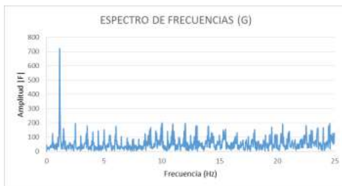
Figura 4.73 Espectro de frecuencia “G” carga estática y dinámica cada 1.0 s.
