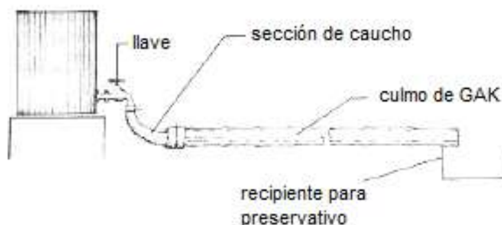
Figura 2.21. Método Boucherie “por gravedad” (Cobos & León, 2007)
