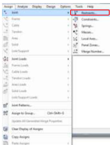
Figura 5.37. Asignar restricciones en juntas en SAP2000.
