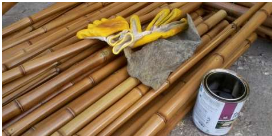
Figura 6.72. Limpieza de hongos en GAK, como parte del mantenimiento (FUNDEGUADUA A. , 2010).
