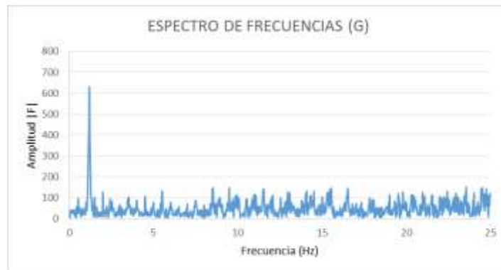
Figura 4.57 Espectro de frecuencia “G” carga dinámica cada 1.0 s.
