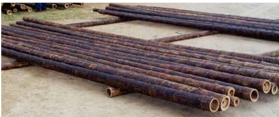
Figura 6.4. Categorización de guadúas rectas y gruesas con diferentes diámetros (Stamm J. , 2010).
