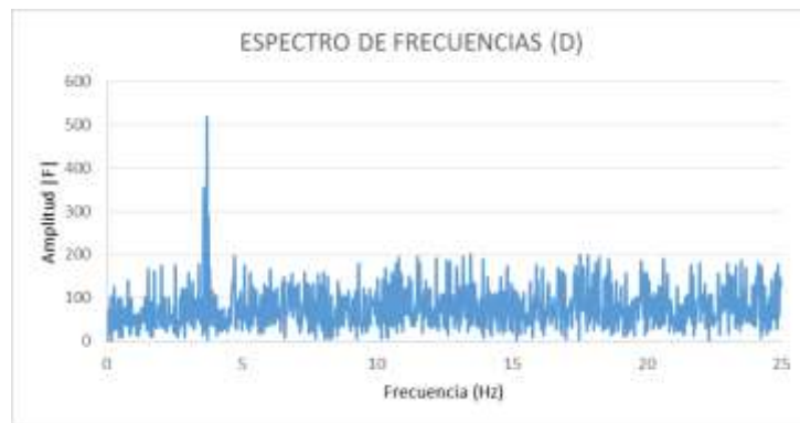
Figura 4.23 Espectro de frecuencia “D”, carga dinámica cada 0.5 s.
