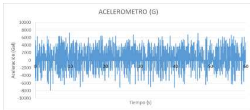
Figura 4.17 Acelerograma sensor “G”, carga dinámica cada 0.5 s.
