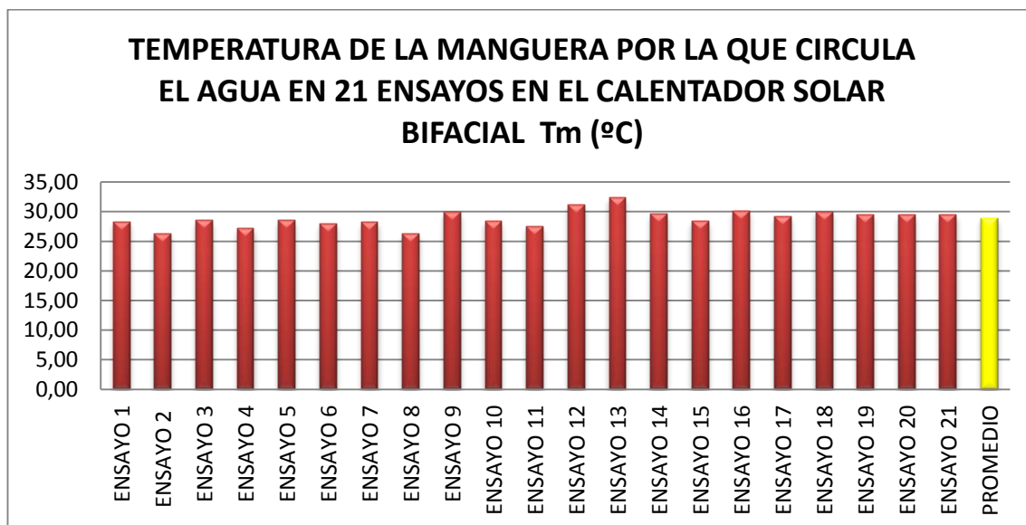
Figura 73: temperatura de la manguera por la que circula el agua en 21 ensayos en el calentador solar bifacial T_m (°C)
