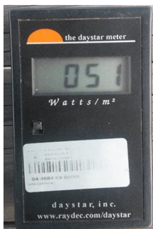
Figura 67: Medidor de radiacion solar
