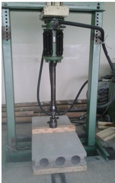
Figura 70: Carga puntual aplicada al panel.
