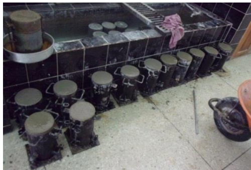
Figura 33: Fotografía de los cilindros para ser desencofrados.
