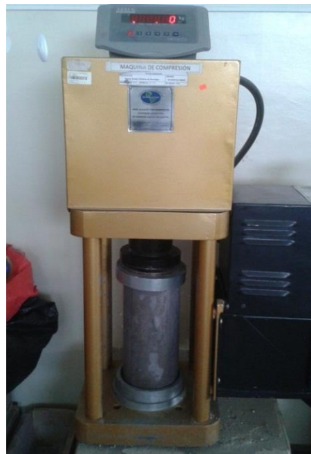
Figura 37: Fotografía de la máquina Universal con probeta.
