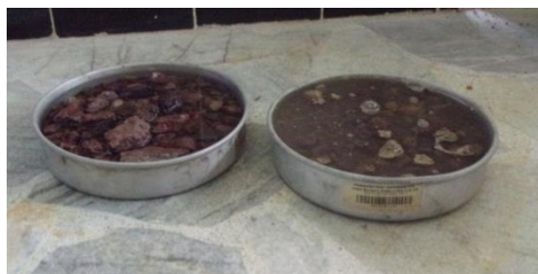
Figura 20: Fotografía saturando material.
