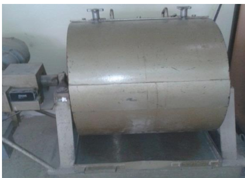
Figura 10: Fotografía de la Máquina de los Ángeles.
