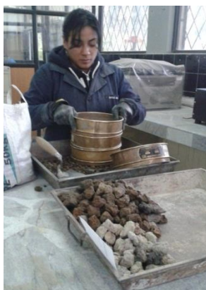
Figura 7: Fotografía tamizando el material.
