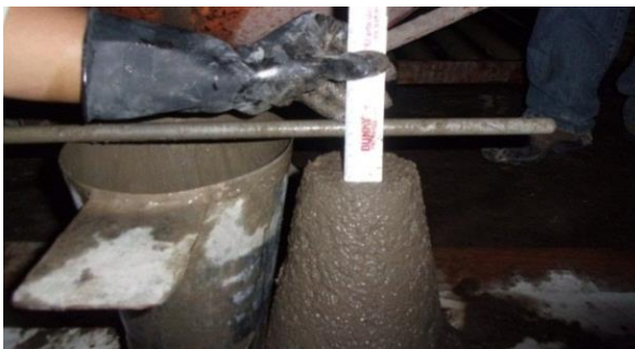
Figura 60: Fotografía del asentamiento de hormigón.
