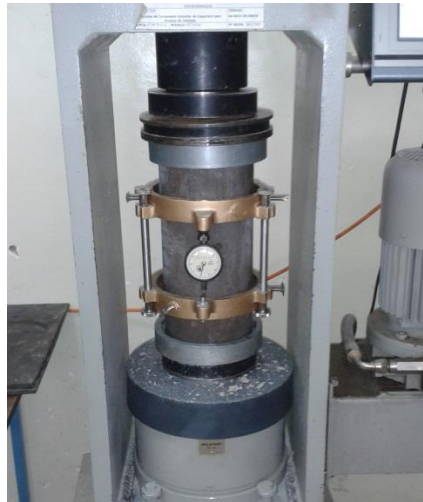
Figura 42: Fotografía del cilindro con el deformímetro.
