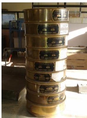
Figura 14: Fotografía de columna de tamices.
