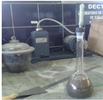
Figura 23: Fotografía del picnómetro con la bomba de vacíos.
