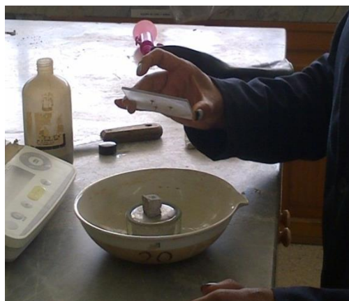
Figura 6: Fotografía de una bandeja con la caja Petri, Mercurio y trozo de Ignimbrita.
