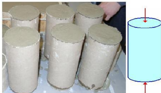
Figura 34: Fotografía de probetas de hormigón para compresión.
