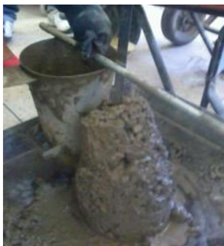
Figura 29: Fotografía del Ensayo cono de Abram.
