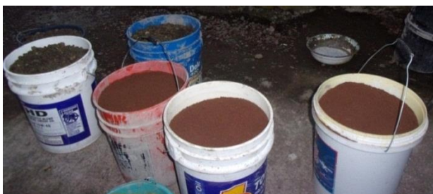
Figura 54: Dosificación en volumen aplicada para la elaboración del panel.
