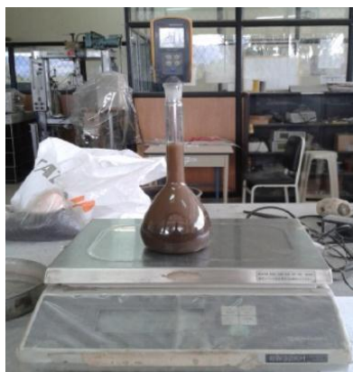
Figura 22: Fotografía de la muestra en el picnómetro.
