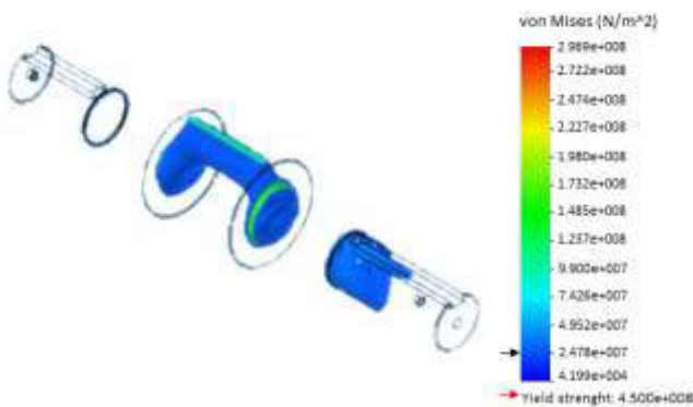
Fig. 13 Representación gráfica del progreso de las tensiones de von Mises en el rodillo inferior (RI).
