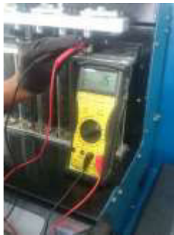
Fig. 6. Medición de la resistencia de los inyectores
