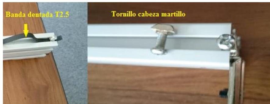
Figura 4.3 Tornillo de cabeza tornillo con banda dentada T2.5
