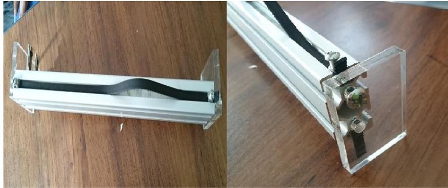
*Figura 4.4 Soporte de acrílico fijo en perfil*
