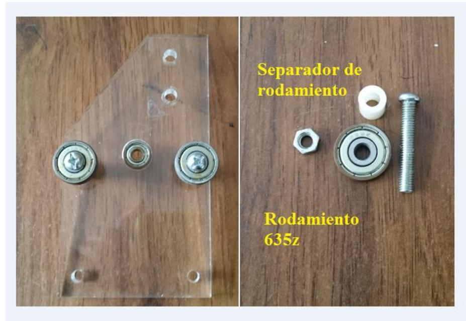
*Figura 4.6 Elementos que conforman sistema de trasmisión*
