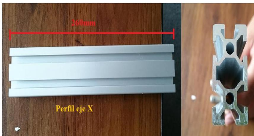
Figura 4.1 Perfil de aleación aluminio T6 para eje X
