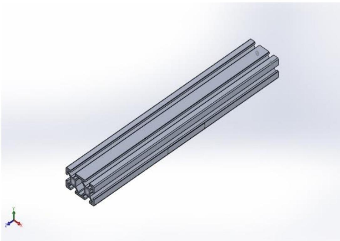
*Figura 3.15 Perfil de aluminio para guía movilidad del eje X*
