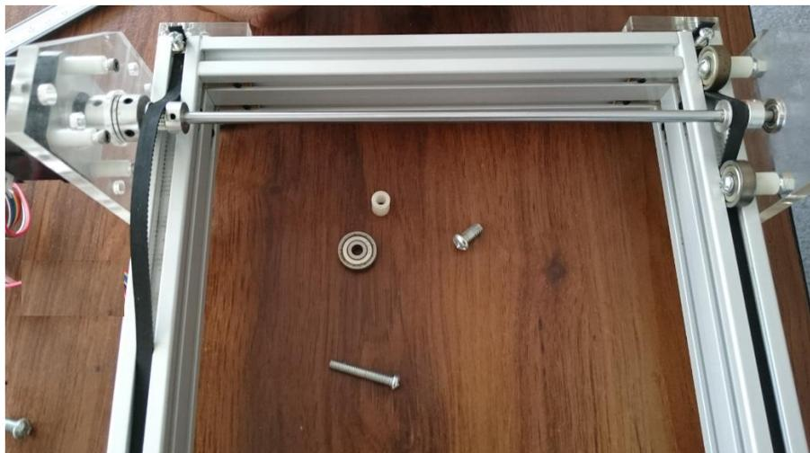
*Figura 4.10 ensamble de eje Y terminada*
