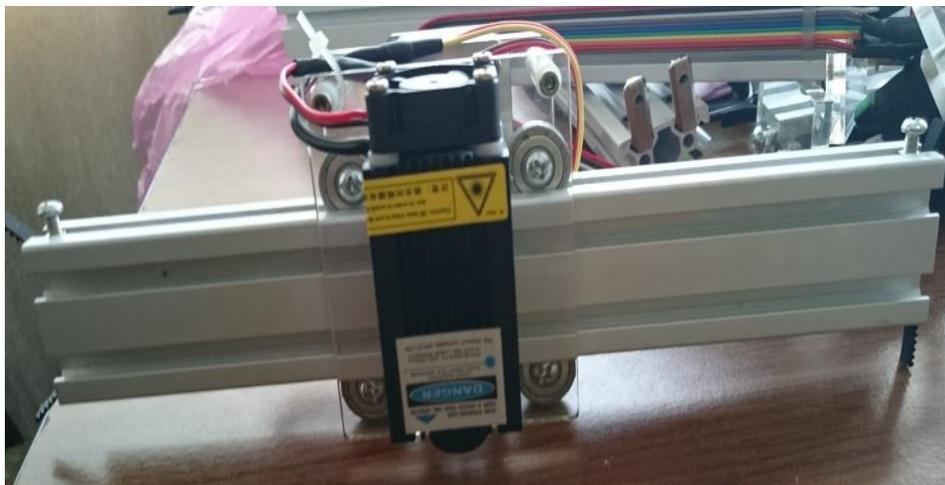
*Figura 4.11 Eje X ensamblado*
