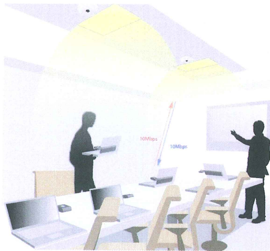
Figura 29 Infraestructura Li-Fi indoor segundo prototipo
