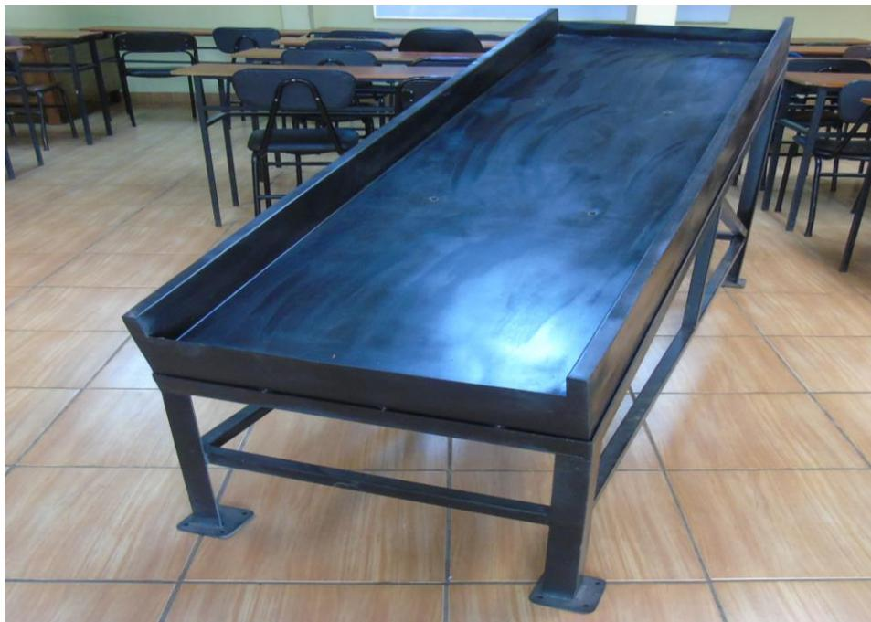
**Figura 48. Colector-almacenador y su bastidor**
