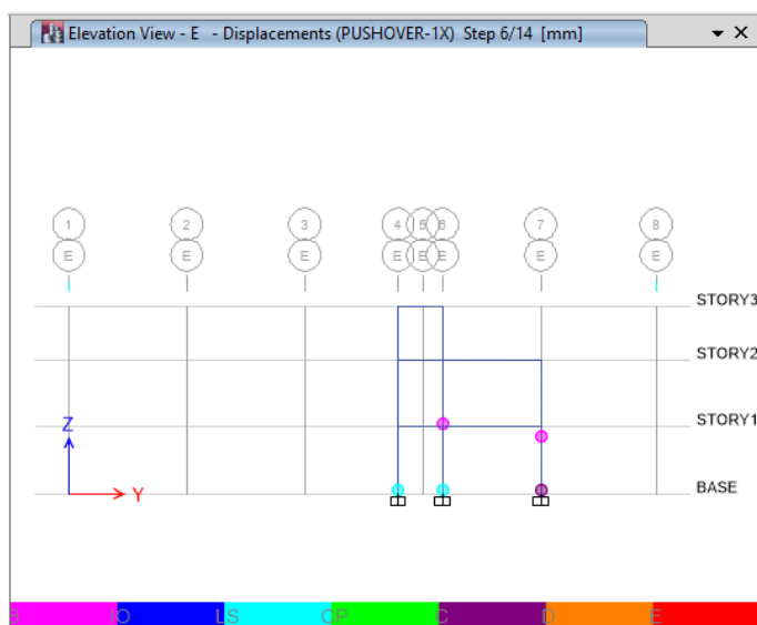
Figura 179. Rótulas plásticas del pórtico E de la hostería del Fuerte Militar “SAN JORGE”. Sentido X.
