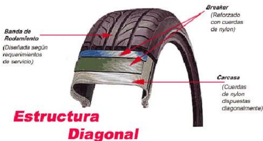
Figura 9. Estructura Diagonal
