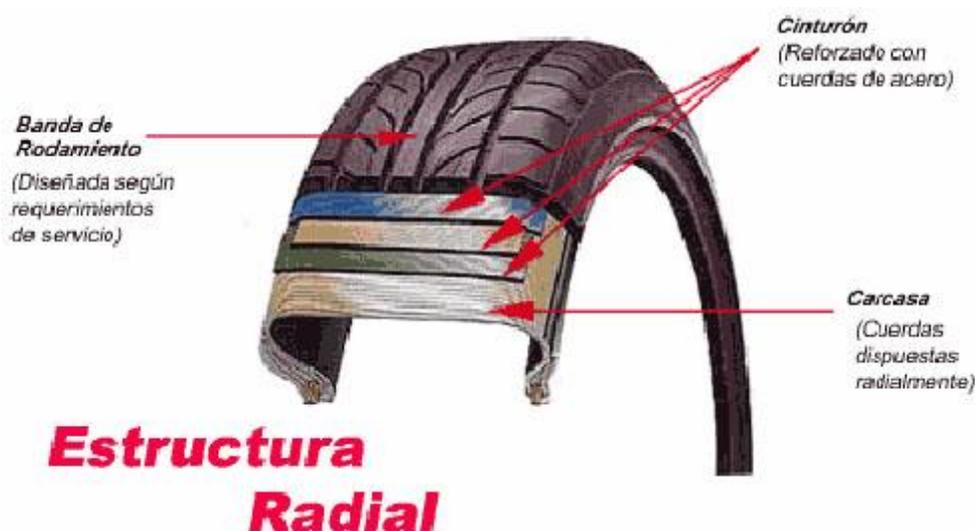
**Figura 10. Estructura Radial**
