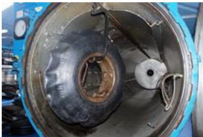
**Figura 16. Armado y Vulcanizado**
